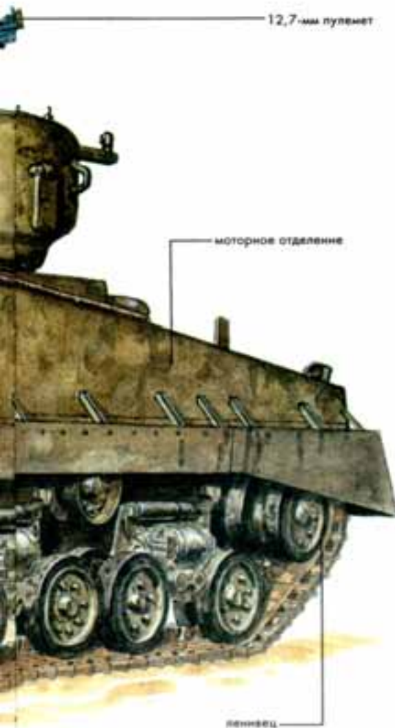
Вес: 33 тонны Скорость: 42 км/ч Лобовое бронирование: 100 мм Вооружение: 1 пушка 76-мм 53 калибра, 2 пулемета
