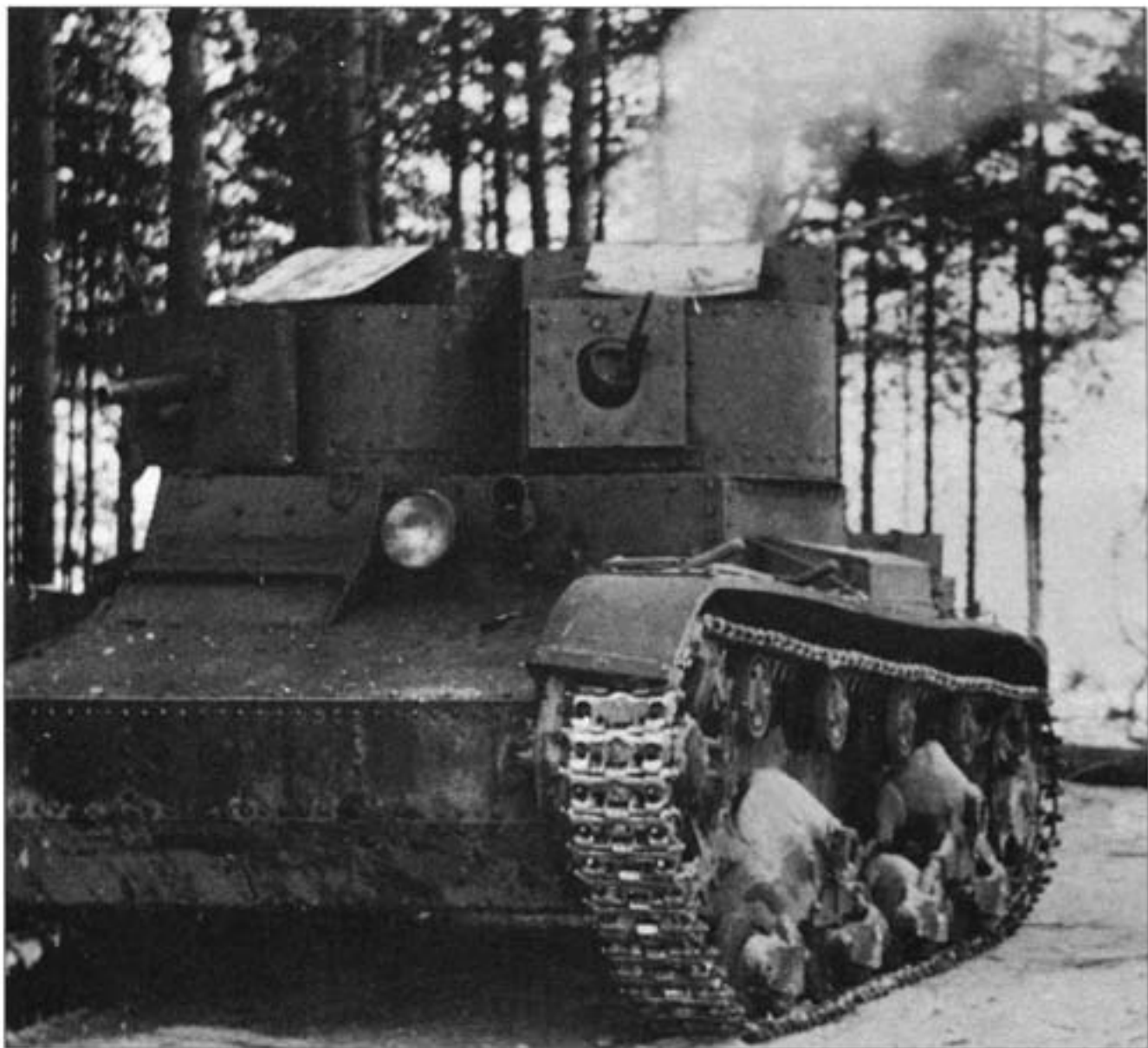
T-26TU образца 1931 г. был оснащен 37-мм пушкой, установленной в левой башне, и 7,62-мм пулеметом ДТ (устанавливался в правой башне). Боекомплект состоял из 180 выстрелов для пушки. Экипаж танка состоял из трех человек. Танк обычно предназначался для командиров рот и взводов.
