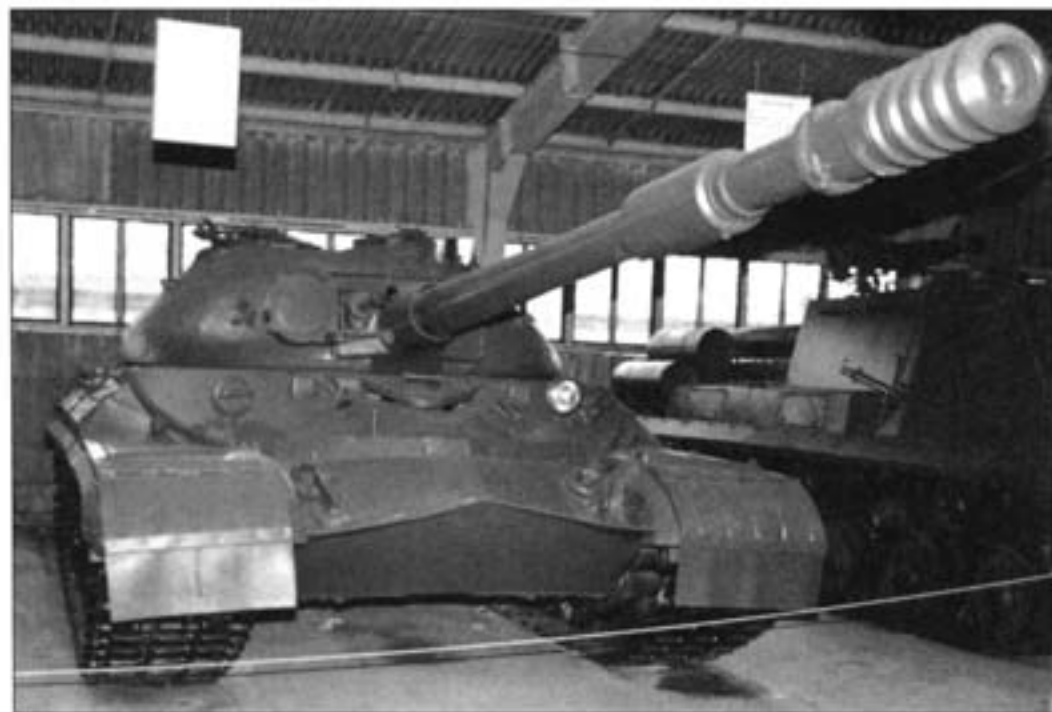
На снимке видно, что предшественниками Т-10М были танки серии ИС. В экипаж машины входили 4 человека. Толщина брони орудийной маски составляла 250 мм. Танк был оснащен большой нарезной пушкой Д-49Т с боекомплектом 30 выстрелов, 20 из них – фугасные, остальные – противотанковые. Размер снарядов был таков, что экипаж мог показывать скорострельность, не превышающую 2–3 выстрела в минуту.
