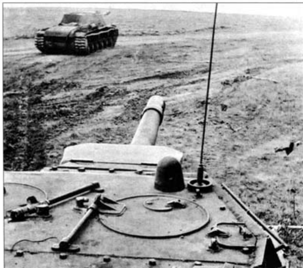
ISU-152 образца 1944 г. на марше. Машина была вооружена 152-мм орудием МЛ-20С. Боекомплект состоял из 20 осколочно-фугасных и бронебойных снарядов. Экипаж – 5 человек. Вес снаряда – 43,4 кг. Максимальная дальность стрельбы – около 10 км. Такое вооружение САУ позволяло успешно бороться с самыми мощными танками противника и обеспечивать поддержку пехоты при штурме немецких укреплений и опорных пунктов.
