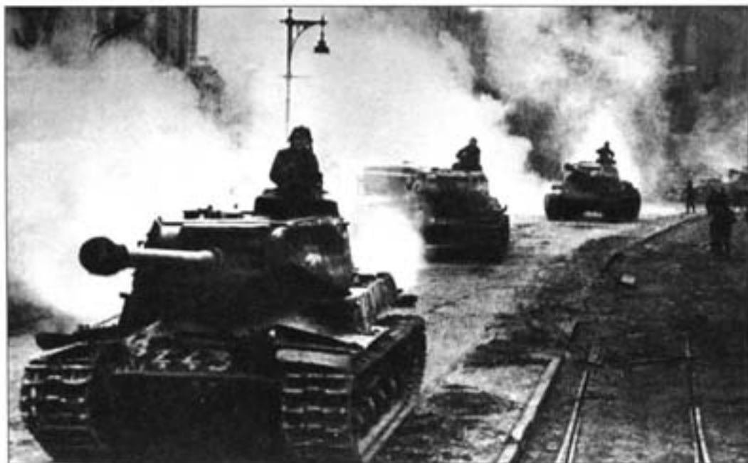
Колонна ИС-2 продвигается по Берлину в мае 1945 г. вскоре после капитуляции Германии. На заднем плане видны полуразрушенные Бранденбургские ворота. На фотографии хорошо видны широкие гусеницы, дававшие танку возможность быстро двигаться по снегу и грязи. Они создавали небольшое удельное давление на грунт и обеспечивали хорошее сцепление.
