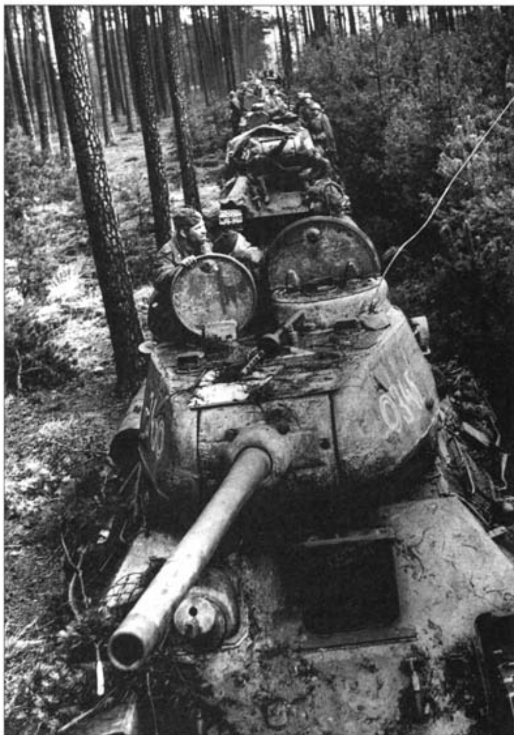
Танки Т-34/85/1 3-й гвардейской танковой армии 1-го Украинского фронта в лесу под Берлином, апрель 1945 г. Т-34/85 имел литую стальную башню и был оснащен 85-мм пушкой ЗИС-53, переделанной из зенитки. Боекомплект танка составлял 55 выстрелов. Хотя шасси Т-34/85 не отличалось от его предшественника Т-34/76, из-за увеличенной толщины брони (60 мм против 45 мм у Т-34/76) и более мощного вооружения скорость танка снизилась до 50 км/ч.
