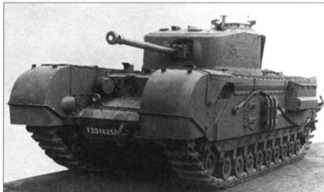
Танки «Черчилль III» начали поставляться в Советский Союз в мае 1942 г. Они были вооружены 57-мм пушками, имели сварную башню новой конструкции и новые воздухозаборники. «Черчилли» широко использовались во время битвы под Курском в 1943 г.
