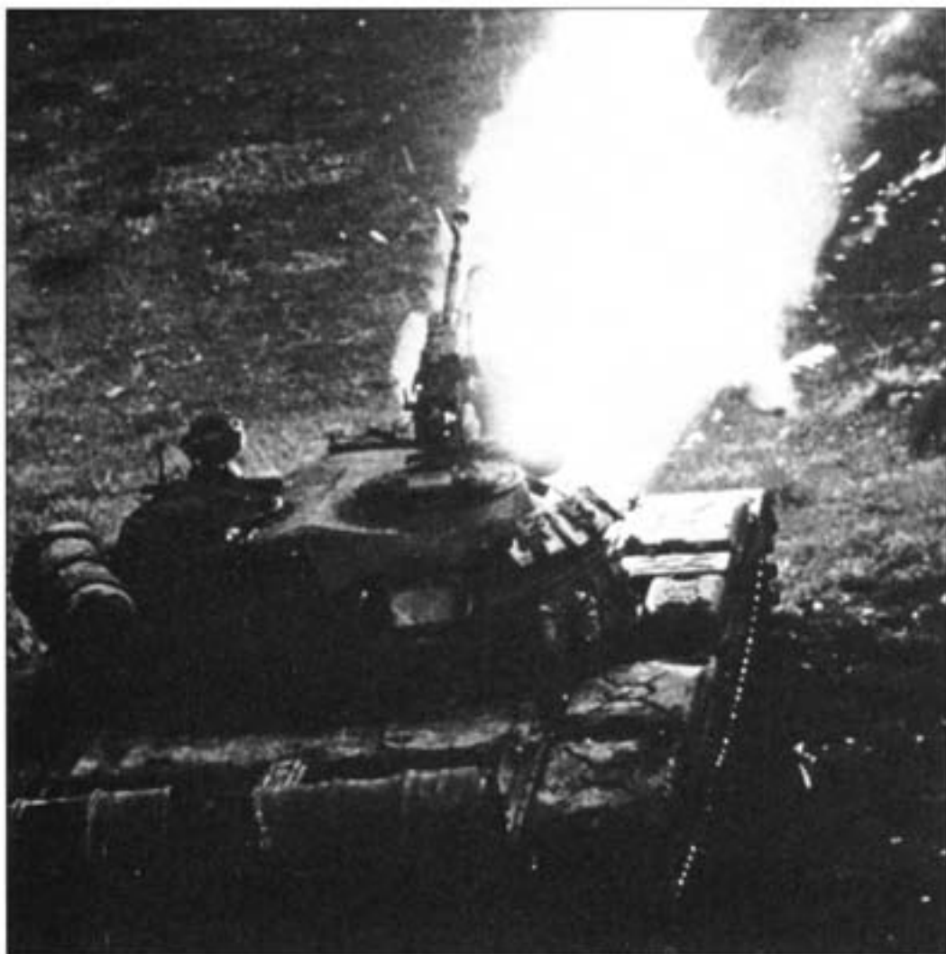
Огнемётный танк Т-54/55 ведёт огонь на ночных занятиях на полигоне. Огнемёт АТО-200 имел запас горючей жидкости в 460 литров, выпуская за один выстрел 35 литров. Темп стрельбы составлял семь выстрелов в минуту. Огнемёт представляет собой оружие устрашения, наводя панику на солдат противника, хотя обычная стрельба часто более эффективна с точки зрения нанесения количественных потерь.
