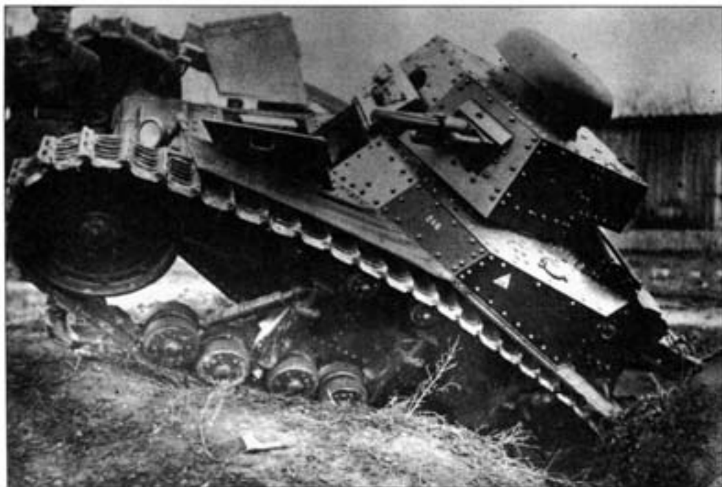
Красноармеец охраняет танк МС-3, застрявший во рве во время учений. «Хаос» танка не помог ему преодолеть ров. МС был оснащен новыми поперечно расположенными двигателем и трансмиссией, а также пружинной подвеской на семи небольших катках. Некоторое количество МС-3 просуществовало до 1941 г. Тогда на них спешно установили 45-мм противотанковые пушки, но МС-3 оказались бесполезными в борьбе с современными немецкими танками.
