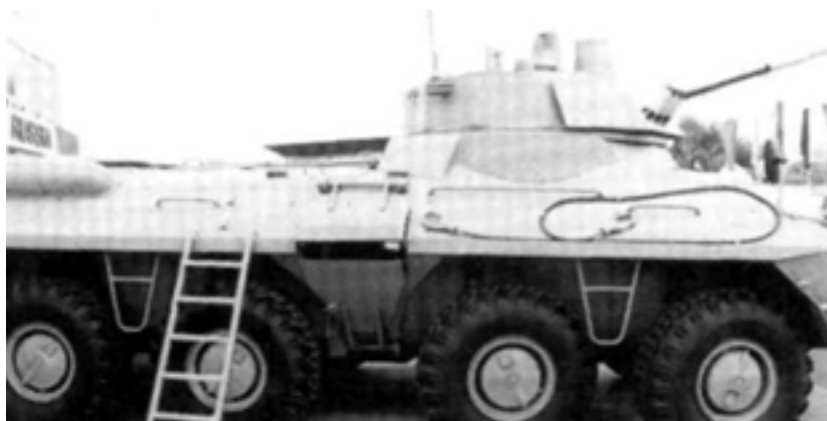
БТР-90 с боевым отделением "Бахча-У". Хорошо видна броневая надстройка на корпусе, на которую устанавливается
