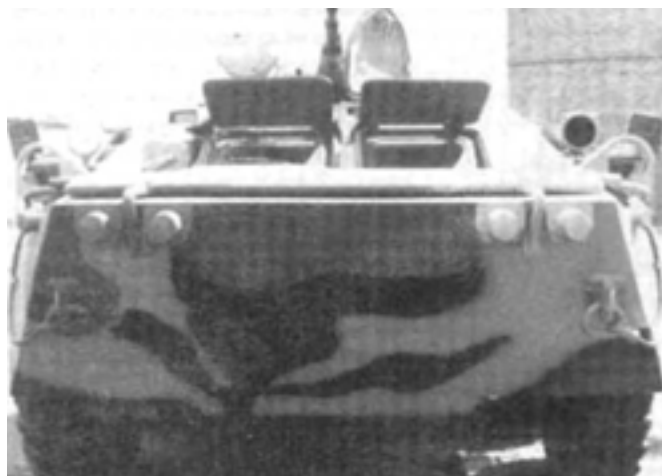
Передняя часть БТР-80 ранних выпусков - передние бамперы имеют округлую форму, позднее они стали прямоугольными.
