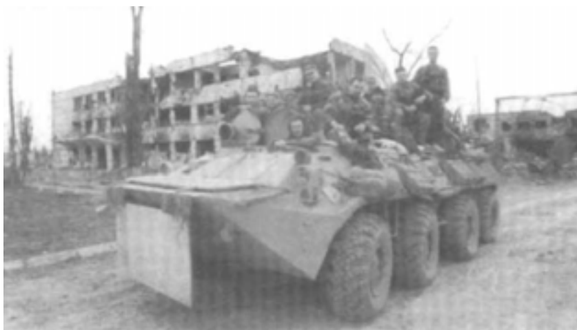
БТР-80 «Саньч» тюменского СОБРа на фоне развалин грозненской обувной фабрики. К передним буферам бронетранспортера прикреплен стальной лист, выполняющий роль противокумулятивного экрана.
