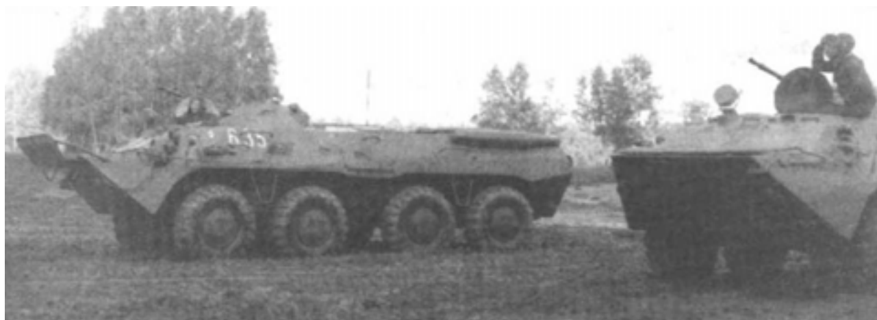
Два БТР-80 ранних выпусков, на редукторах колес установлены защитные броневые колпаки. У переднего БТРа волноотражательный щиток опущен, у заднего - поднят.
