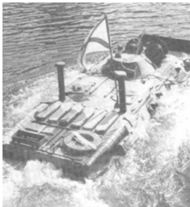
БТР-80 преодолевает водное препятствие. На воздухозаборники двигателя и ФВУ установлены удлинительные трубы, для предотвращения заливания их водой.
