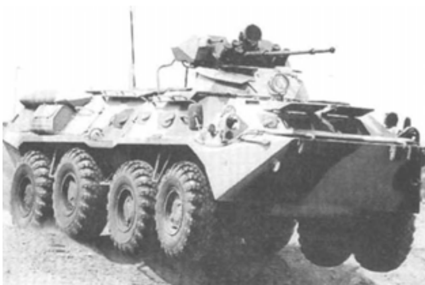
БТР-80А имеет существенно усиленное вооружение, состоящее из 30-мм пушки и спаренного с ней 7,62-мм пулемета ПКТ.
