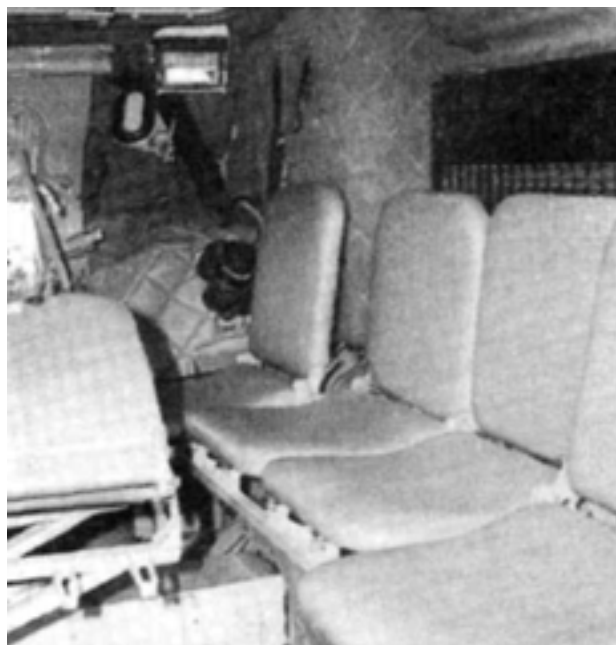
В отличие от БТР-80/70 сиденья десанта в новом бронетранспортере развернуты к продольной оси.
