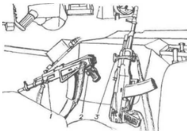
Укладка автоматов на нише правого переднего колеса (слева в наклонном положении, справа в вертикальном положении). Цифрами обозначены: 1. и 2. клипсы; 3. хомут.
