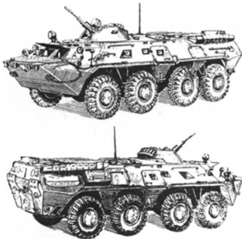
Бронетранспортер БТР-80 поздних выпусков (Вид слева - сверху, вид справа - внизу). Эти машины отличались установкой осветителя ОУ-3ГА2М на консоли пулеметной установки для освещения целей при стрельбе ночью.
