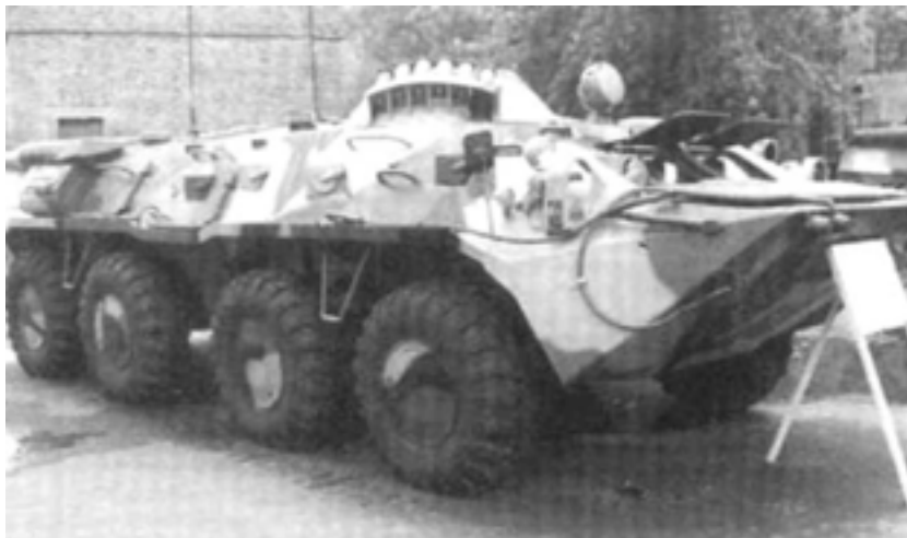
На БТР-80 для улучшения возможностей маскировки была установлена система пуска дымовых гранат 902В «Туча». Она монтировалась на задней части башни и хорошо видна на этой фотографии (сами башня развернута влево).
