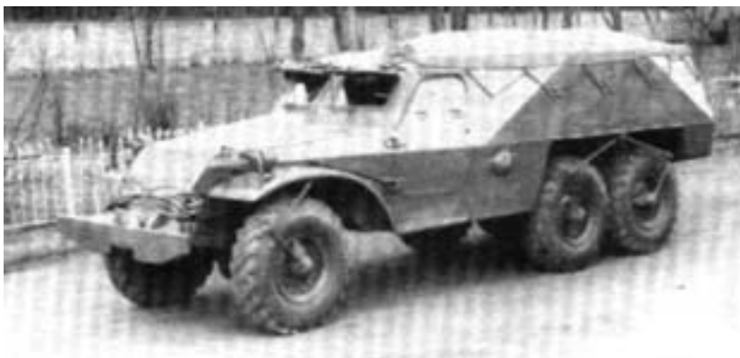
БТР-152В1 с штангами внешней подкачки колес.
