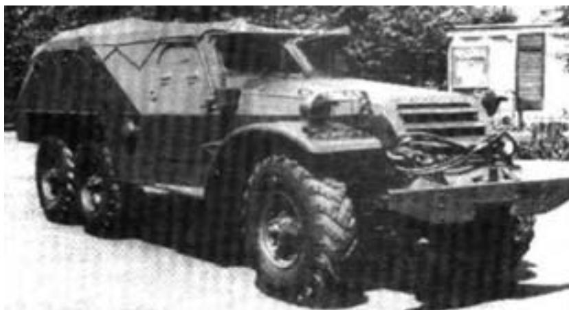
БТР-152В1 с внутренней подкачкой колес.
