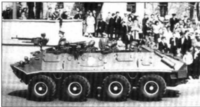
БТР-60П с нестандартным вооружением - 12,7-мм пулеметом ДШК в передней части корпуса и двумя 7,62-мм пулеметами СГМБ по бортам.
