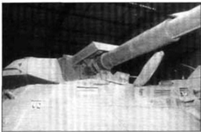
На фото хорошо видны тормозные устройства пушки прикрытые сверху броневой коробкой.
