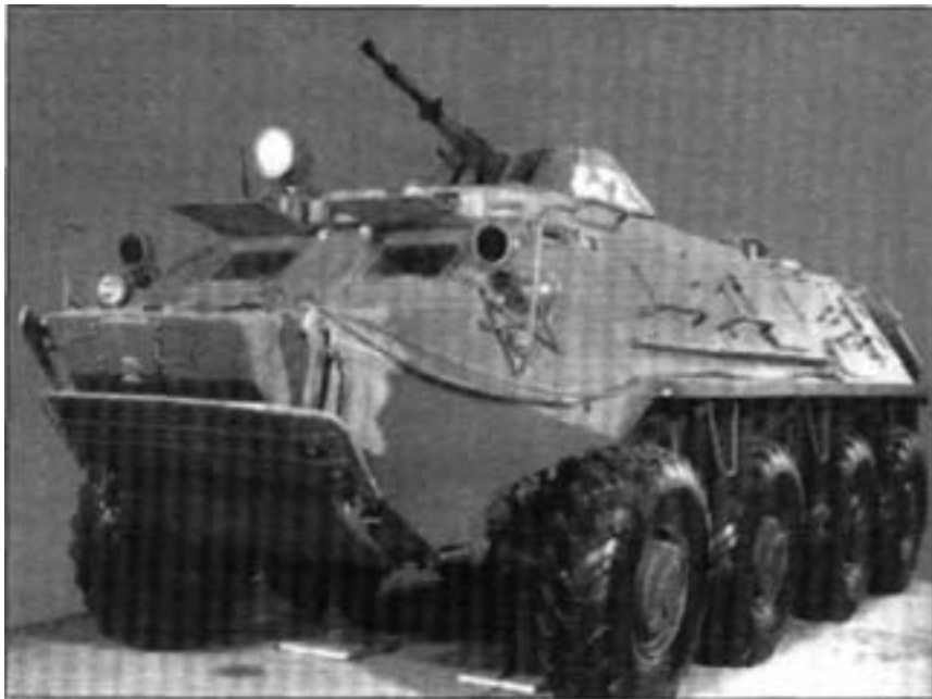
Вверху: Опытный образец БТР-60ПБ в экспозиции танкового музея в Кубинке. БТР-60ПБ - наиболее удачный и массовый вариант «шестидесятой» отличался установкой бронированной башни с крупнокалиберным пулеметом КПВТ.
