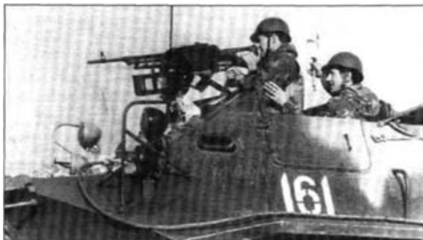
БТР-6011 недолго находился на вооружении армейских подразделений «первого эшелона», гораздо дольше он продержался в морской пехоте. Этот БТР-60П морской пехоты, сфотографированный во время учений «ЮГ» в июле 1971 года, вооружен более современным 7,62-мм пулеметом ПКМ. Ограждение фар как на более позднем БТР-60ПА ...
