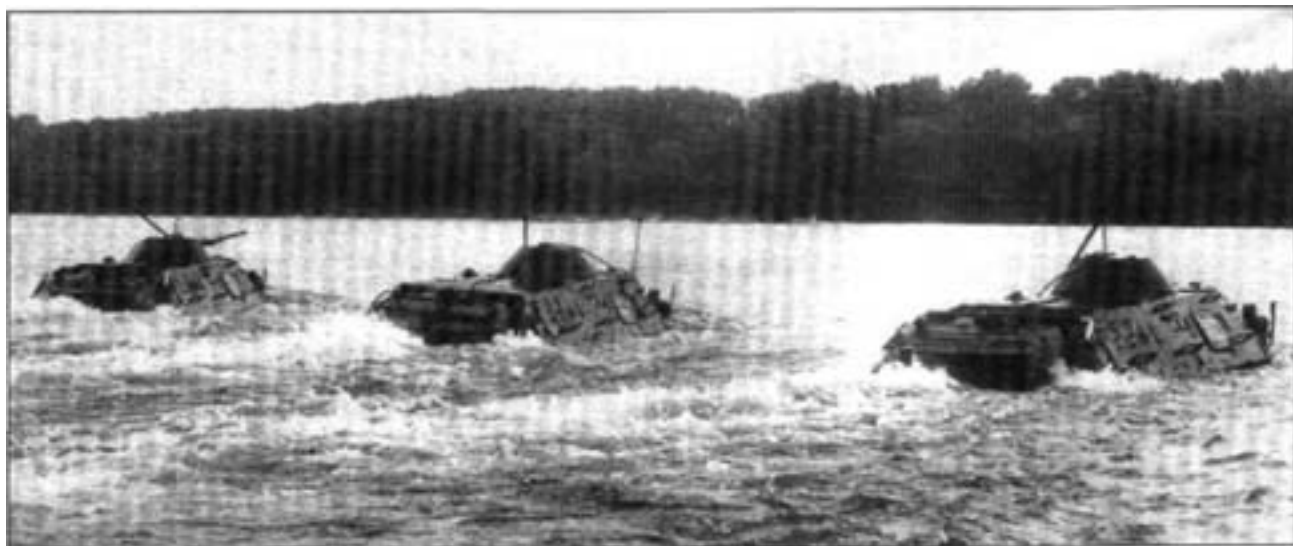
Группа БТР-60ПБ форсирует реку. На воде эти машины развивали скорость до 10 км/час.
