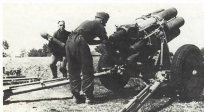
Немецкий аналог "катюши" – 150-мм "химический" миномет ("ванюша")
