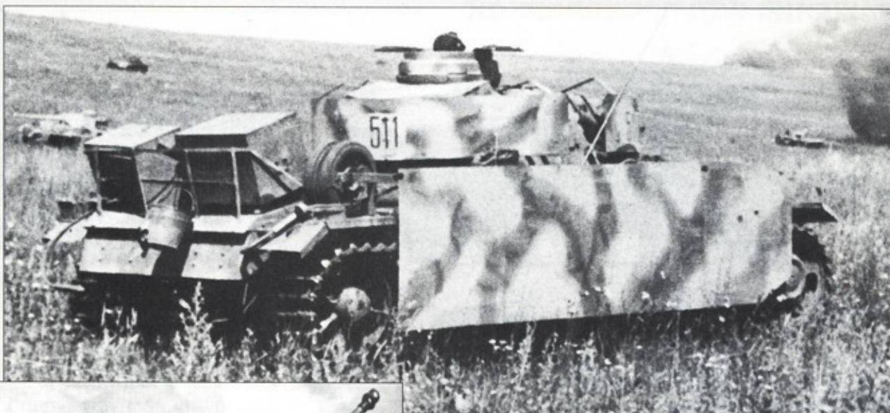
В бой идет германский средний танк Т-III L, увешанный дополнительными бортовыми экранами. Из-за недостаточного обзора командир танка вынужден высовываться из своего люка
