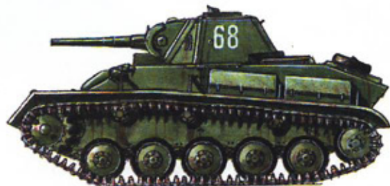
Легкий танк Т-70 Экипаж 2 человека Масса – 9 тонн Вооружение: пушка калибра 45 мм и один пулемет Толщина лобовой брони – 45 мм
