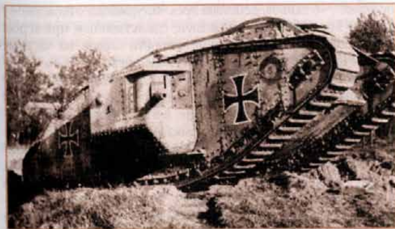
Mk IV («Beutepanzerwagen IV»), перевооруженный 57-мм пушкой Максима-Норденфельда, в составе германского танкового «штурмового отделения».
