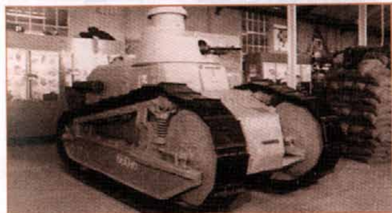
Пулеметный «Рено» FT-17 с литой башней из первой опытной серии.
