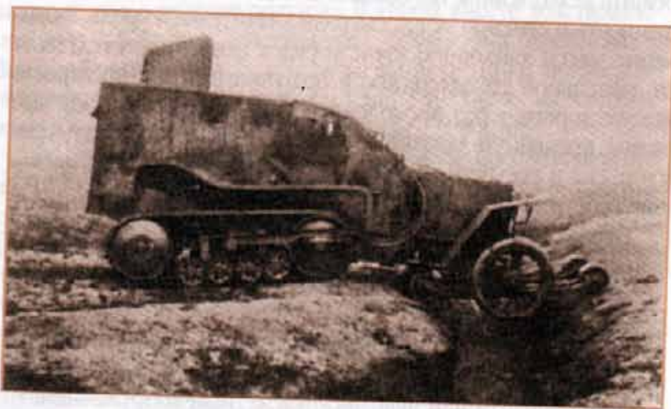
Бронеавтомобиль «Пежо», снабженный в опытном порядке полугусеничным ходом по схеме Кегресса после того, как сам Кегресс вернулся во Францию.
