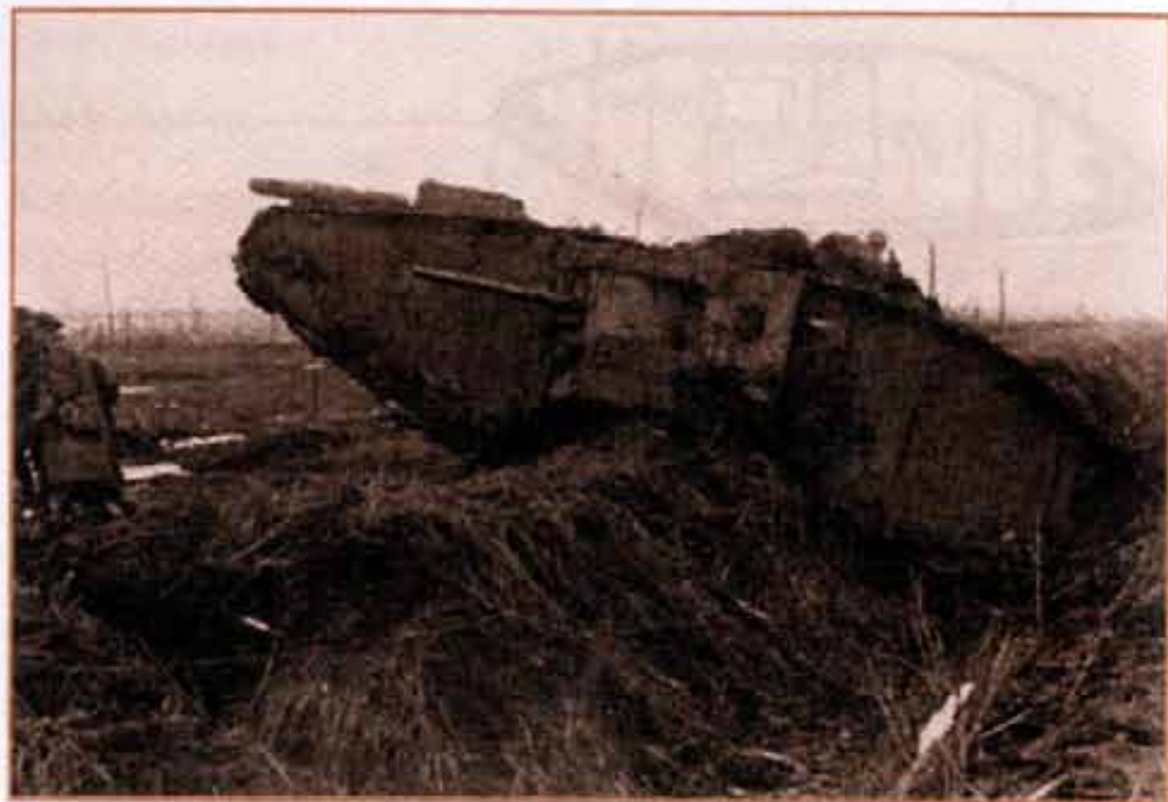
Mk II «самец» преодолевает ров. На передней части танка видна балка самовытаскивания.
