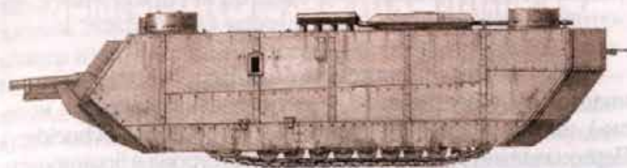
Прототип танка «Сен-Шамон» с цилиндрическими башенками и бронированием ходовой части.
