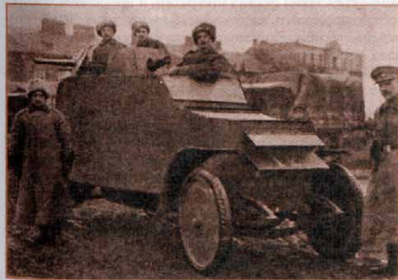
Легкий бронеавтомобиль на шасси «Рено», вооруженный 37-мм пушкой и пулеметом, по схеме штабс-капитана Некрасова.
