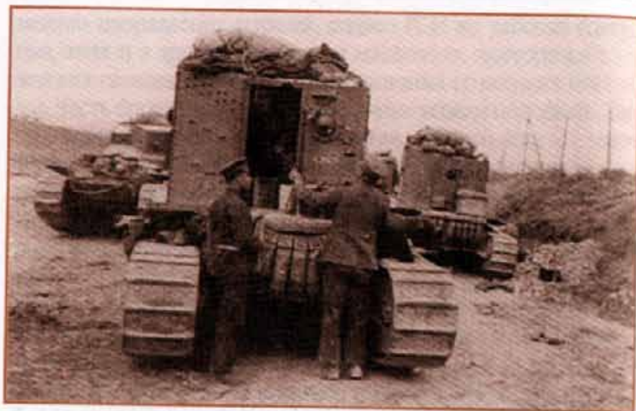
Мк А «Уиннет» готовят к бою. Хорошо видны шаровая установка в кормовой двери и крепление канистр. 28 марта 1918 г.
