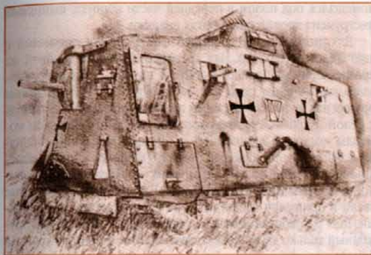
Рисунок танка A7V №563 «Вотан» третьего «штурмового отделения». Через открытую переднюю дверь видна лестница на верхнюю площадку.
