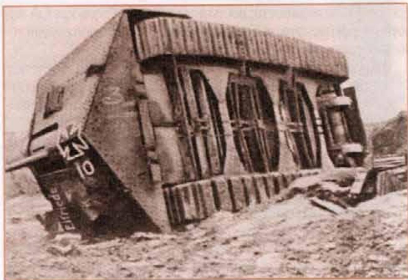
Опрокинувшийся при переходе через воронку танк № 542 «Эльфриде» — A7V был малоустойчив на пересеченной местности.
