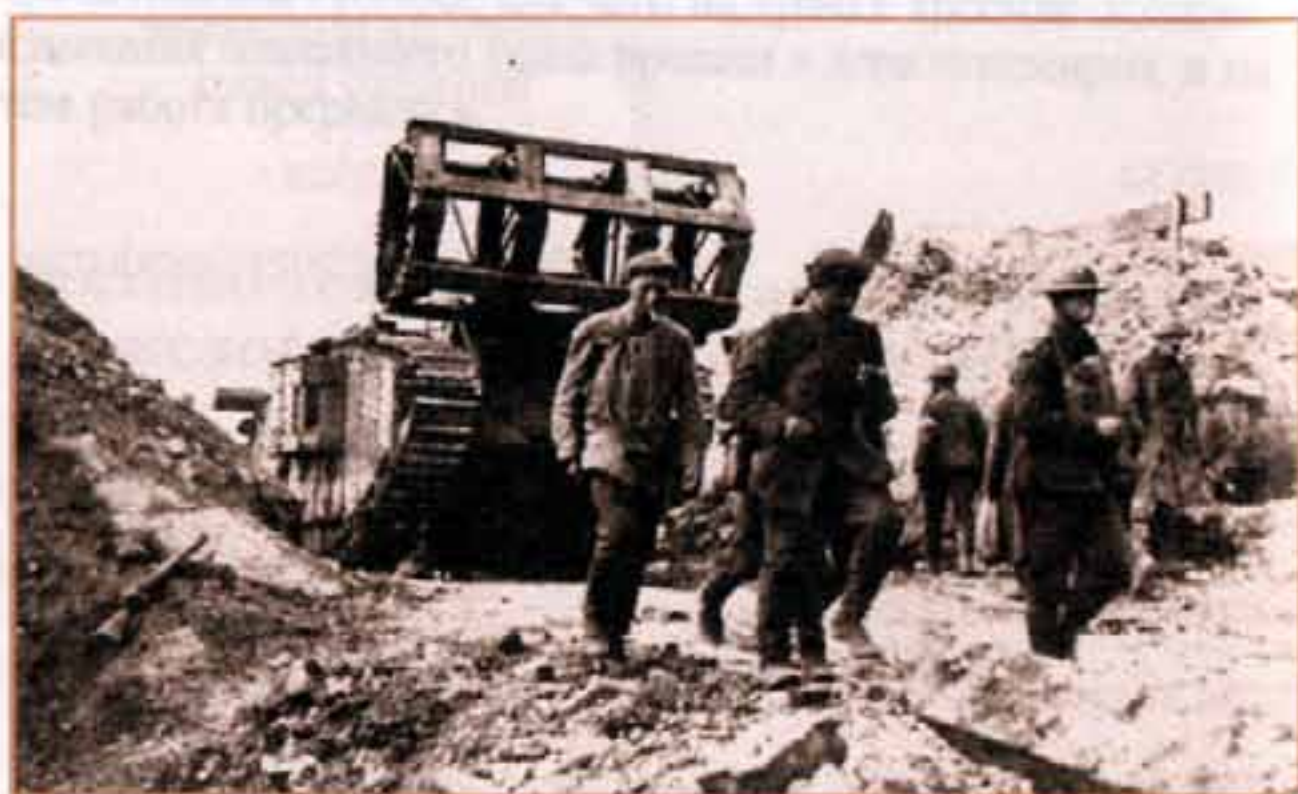
Mk IV «самка» с приспособлением «crib» для преодоления окопов.
