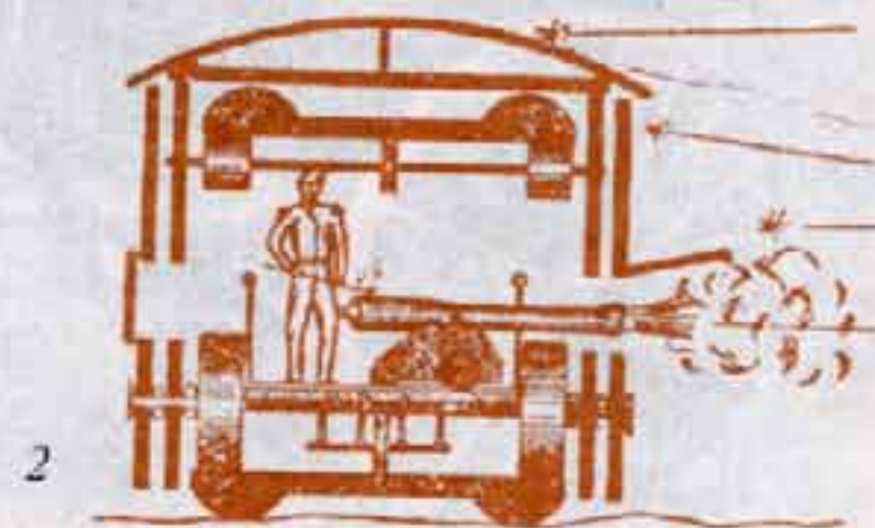
Устройство гибкой гусеницы по проекту Буйена (1). Установка орудия в «поезде» Буйена (2).
