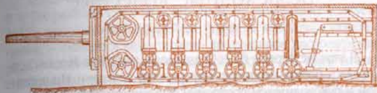
Для стрельбы гусеничный «Бронированный автомобиль» Менделеева должен был ложиться корпусом на грунт.
