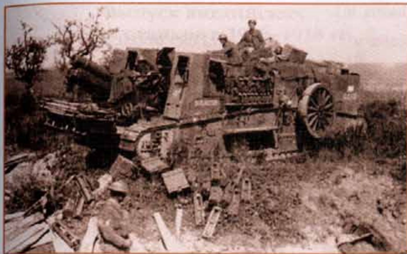
Танк-транспортёр GC «Дарлингтон» с 6-дм гаубицей и запасом выстрелов.
