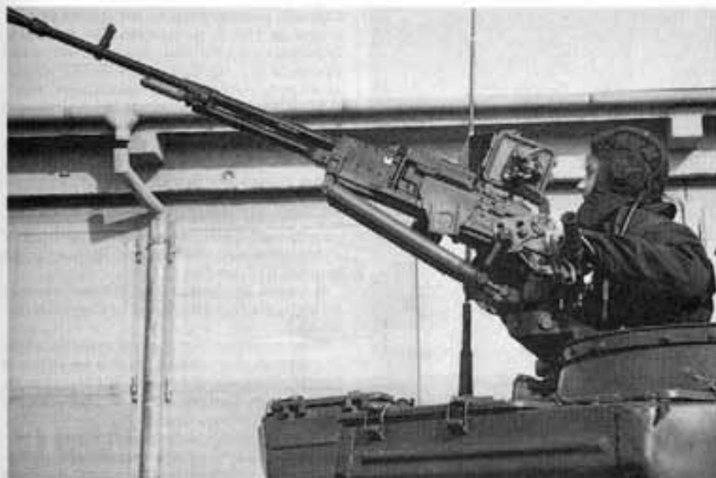
Установка зенитного пулемета НСВ-12,7 в боевом положении
