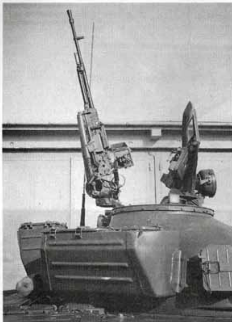
Зенитно-пулеметная установка на максимальном угле возвышения: +75°
