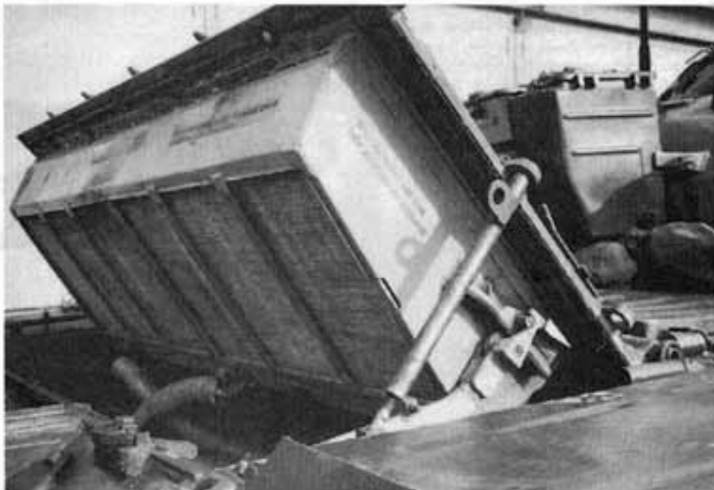
Крыша со стеллажом радиаторов в подня- том положении
