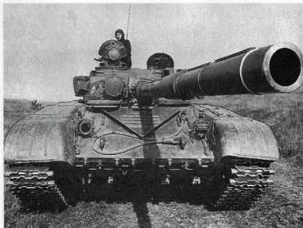
Танк Т-72 выпуска после 1975 года. На пушке — теплозащит- ный кожух
