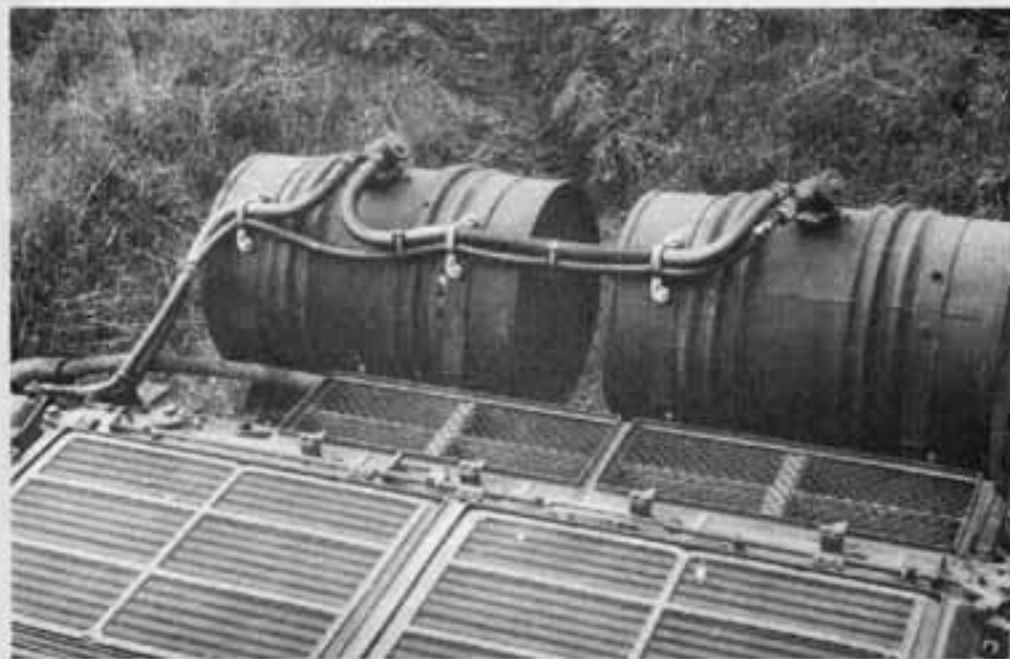
Дополнительные бочки и оборудование для их подключения к топливной системе
