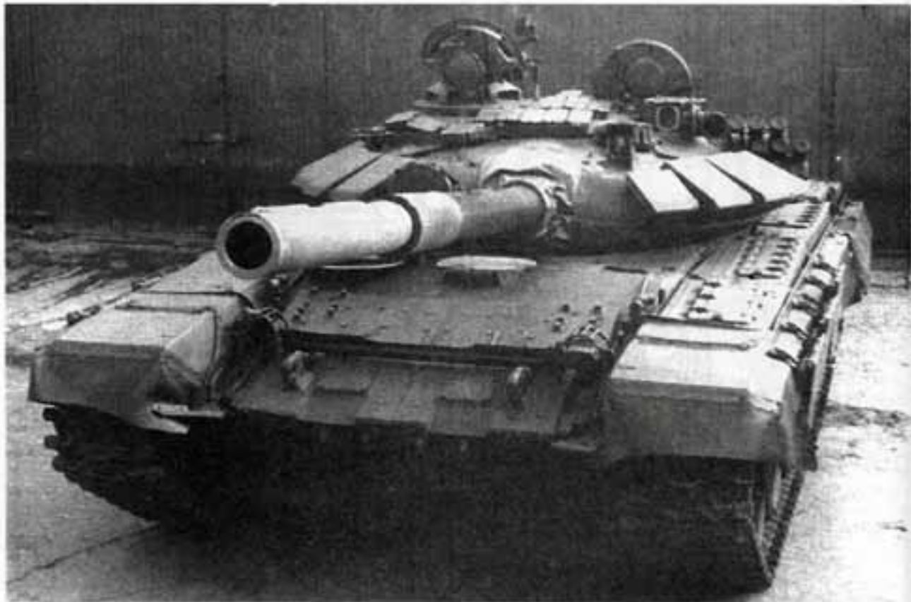
Танк Т-72М. Крышка амбразуры защитного кожуха прицела-прибора наведения 1К13 в боевом положении, то есть — открыта
