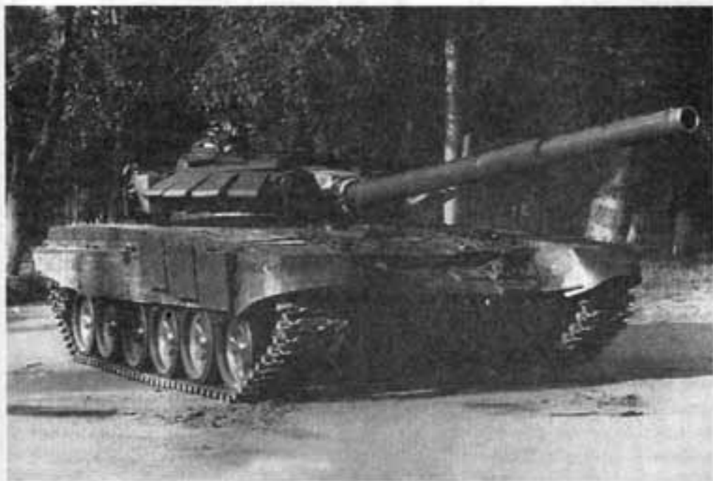
Танк Т-72БМ со встроенной динамической защитой. 1989 год
