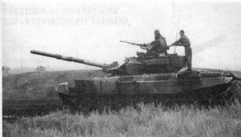
Танк Т-90С на выставке ВТТВ «Омск-99». На этой машине установлена сварная башня и двигатель В-92С2
