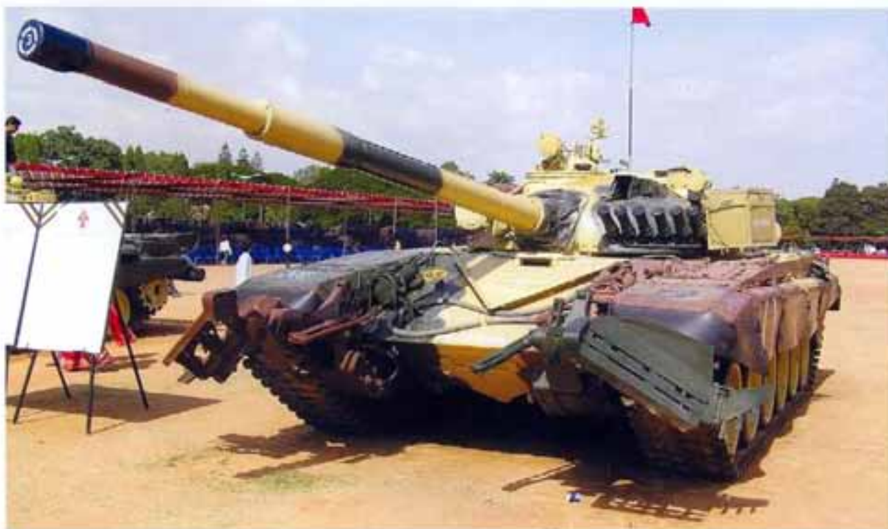
Танк Т-72М1 индийского производства. На машине установлен колесный ножовой минный трал КМТ-5. Internet
