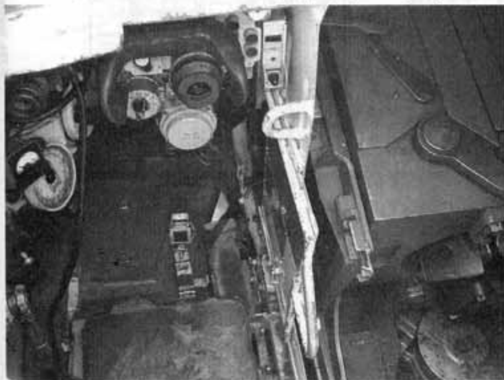
Внизу — Вид на рабочее место наводчика через его люк. Хорошо видны налобник и окуляр прицела-дальномера ТПД-К1
