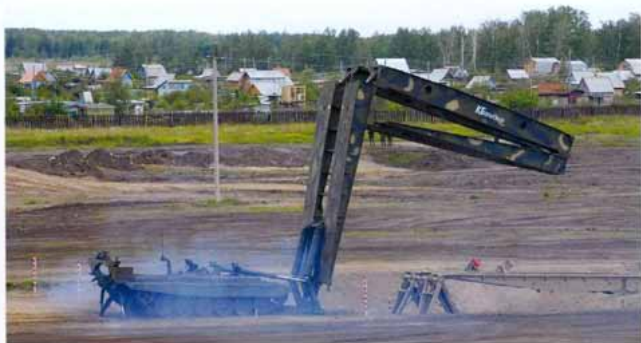
Танковый мостоукладчик МТУ-90. Фото А. Аксенова
