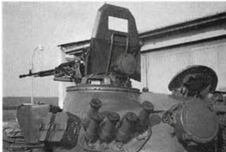
Вид на правую сторону башни. Здесь установлены пять пусковых установок системы «Туча»
