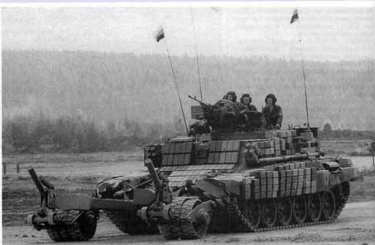
БМП-3М с колеиным минным тралом КМТ-7 с электромагнитной приставкой ЭМТ. В отличие от БМП-3 модернизированная машина оснащена комплексом динамической защиты
