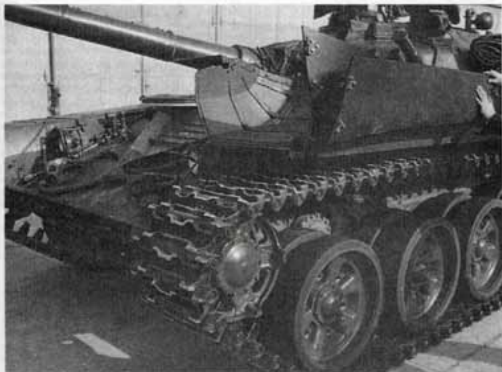
Гусеничная цепь с резинометаллическим шарниром. Для ее демонстрации на танке Т-72А пришлось отогнуть резиноканевые бортовые экраны и откинуть грязевой щиток
