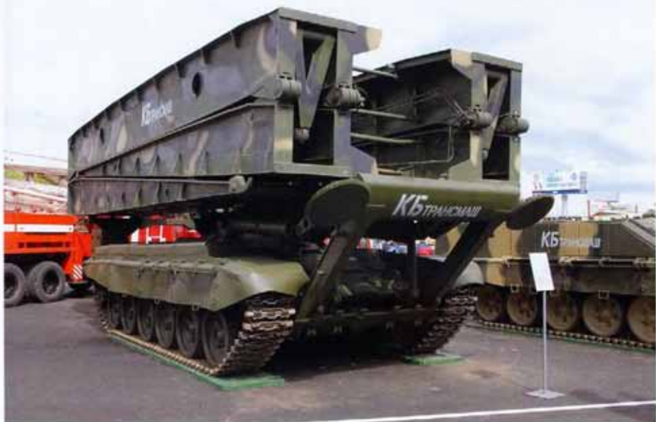
Танковый мостоукладчик МТУ-90. Фото А. Аксенова
