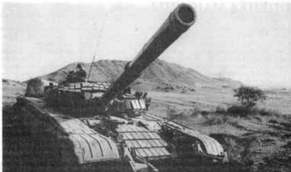
Танк Т-725 азербайджанской армии на боевой позиции. Машина оборудована колейным ножовым минным тралом КМТ-6. Азербайджан, Агдамский район, май 1992 года
