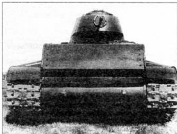
Танк СМК на полигонных испытаниях, вид с кормы. Август 1939 года. Хорошо видна установка пулемета ДК.
