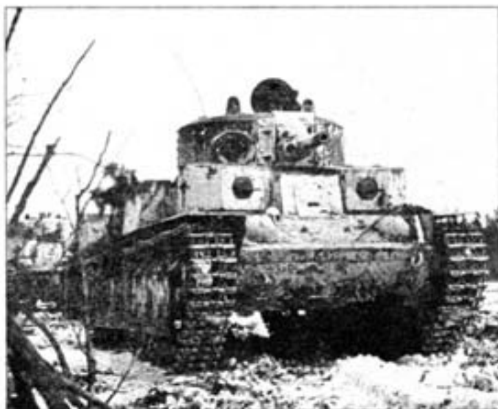
Танки 20-й тяжелой танковой бригады выдвигаются на рубеж атаки. Район высоты 65,5, февраль 1940 года. Головная машина (выпуска второй половины 1939 года) имеет штыревую антенну, улучшенную бронировку перископов и люк для приборов дымопуска с наклонными бортами.
