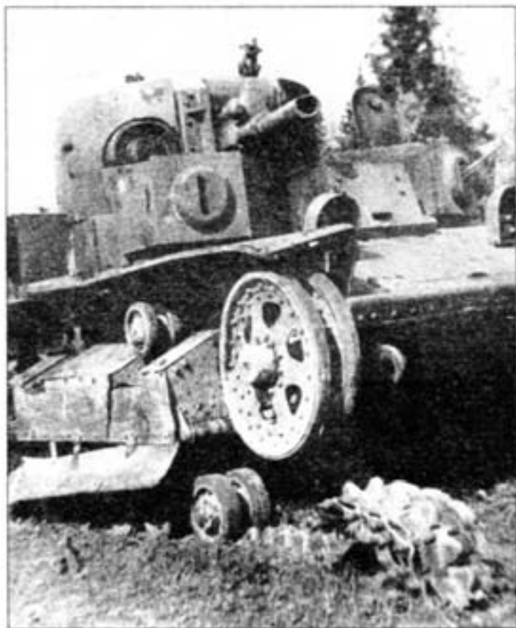
Заминированный Т-28, подбитый в районе Красногвардейска. Август 1941 года. На броне видно не менее пяти снарядных попаданий калибра 37–50 мм, но ни одной пробоины.
