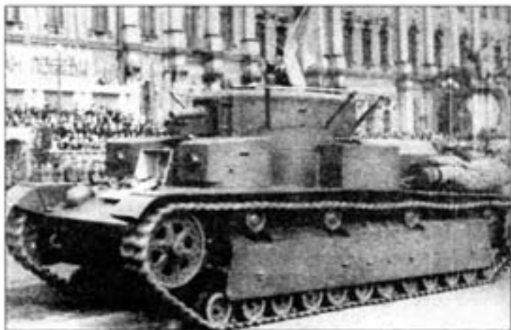
Т-28 во время парада на площади Урицкого. Ленинград, 1 мая 1936 года. На фото танк выпуска 1935 года с измененным глушителем, кожухом над вентилятором и укладкой ЗИП. Машина имеет опорные катки раннего типа, металлические катки стоят только на 4-й каретке подвески.
