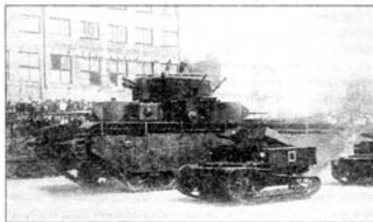
Первый серийный Т-35А в окружении танкеток Т-27 на параде в Харькове. 1 ноября 1933 года. 76-мм орудие еще не имеет маски и смонтировано во временной установке.
