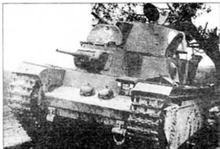
Брошенный Т-35 с коническими башнями. Июль 1941 года. Танк 1939 года с прямой подбашенной коробкой. Белый треугольник на башне — предположительно тактический знак 68-го танкового полка.
