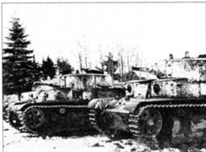
Танки перед выходом на боевую операцию. Карельский перешеек, февраль 1940 года. Передний танк выпуска конца 1939 — начала 1940 года с улучшенной бронировкой перископов наблюдения и ящиком для приборов дымопуска с наклонными бортами, задний танк выпуска первой половины 1939 года.
