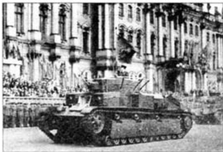
Т-28 на площади Урицкого. Ленинград, 1 мая 1936 года. На фото машина выпуска 1933–1934 года с ранним типом глушителя, кожух над вентилятором не имеет жалюзи, опорные катки раннего типа.
