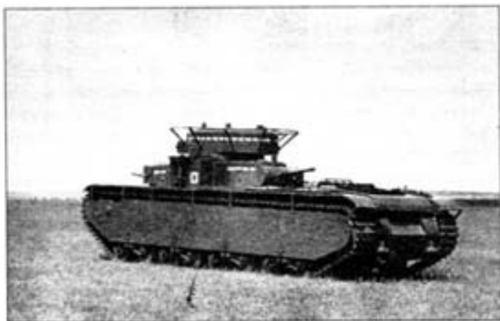
Т-35 5-й тяжелой танковой бригады на учениях. Район Харькова, лето 1936 года. Лестница для залезания на танк уложена на крыше моторного отделения поверх глушителя.
