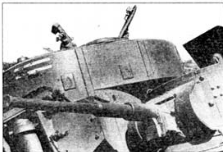
Тот же танк, что и на предыдущем фото: на башне видны две белые полосы — тактический знак 67-го танкового полка 34-й танковой дивизии — и след от попадания 37-мм снаряда.
