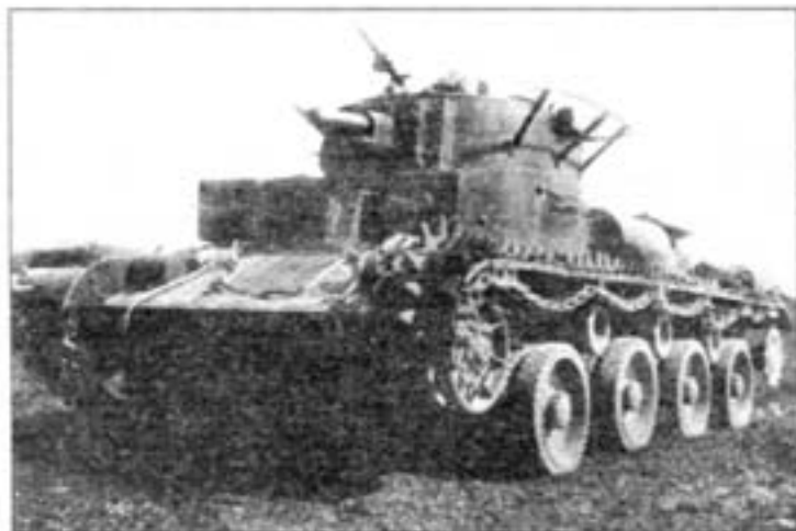
Эталонный образец танка Т-29 с пушкой ПС-3 на испытании. 1936 год. При помощи синхронизаторов эта машина могла двигаться на одной гусенице и колесах.
