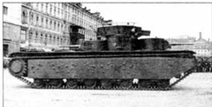
Модернизированный образец танка Т-35 с бортовыми экранами измененной конфигурации по пути на Красную площадь. 1 мая 1940 года. На экране хорошо видны петли люков для доступа к подвеске.
