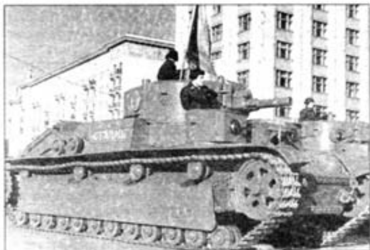
Именной танк «Сталин» по пути на Красную площадь. Москва, 7 ноября 1939 года. Вооружен пушкой Л-10 с наклонными бортами ящиков дымопуска и усиленной бронировкой приборов наблюдения.
