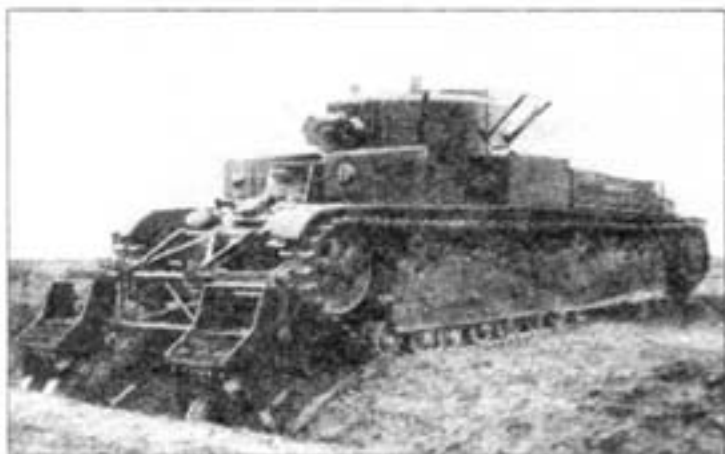
Танк Т-28 с колеиным минным тралом во время испытаний преодолевает траншею. НИИТ полигон, июнь 1939 года (АСХМ).
