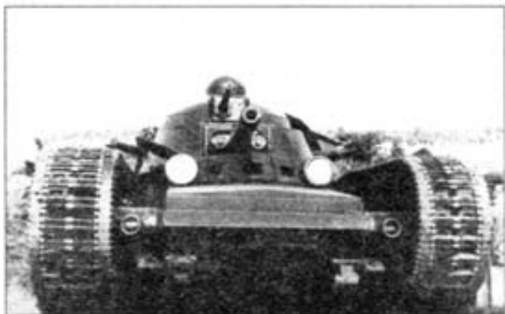
Вид спереди на ТТ. Лето 1931 года. Хорошо видна конструкция гусениц.
