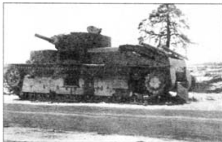
Экранированный танк Т-28, брошенный из-за поломки летом 1941 года. Хорошо видна экранировка кормы корпуса и лока для доступа к трансмиссии. Район Ленинграда, осень 1941 года.
