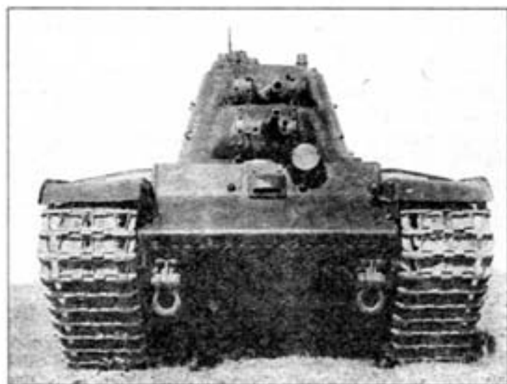
Танк Т-100 на полигонных испытаниях, вид спереди. Август 1939 года. Хорошо видна форма траков гусеницы.
