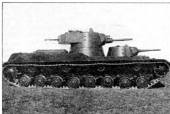
Танк СМК на полигонных испытаниях, вид с правого борта. Август 1939 года. Хорошо виден 12,7-мм пулемет ДК в нише большой башни.
