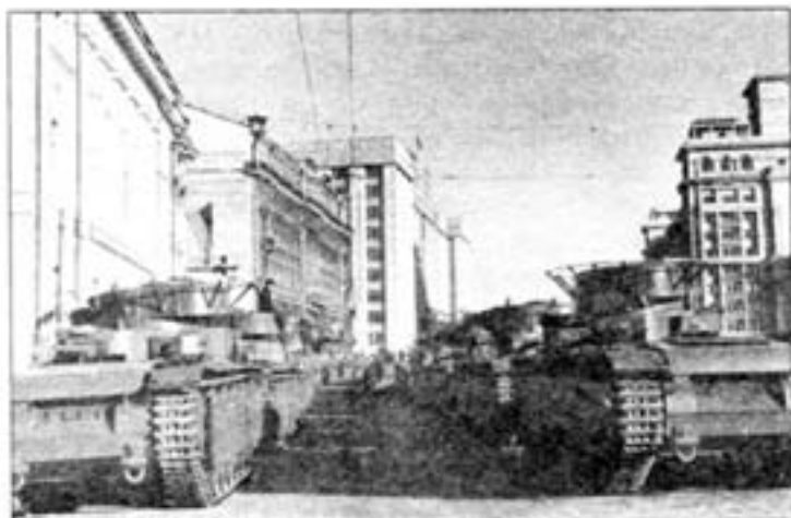
Танки Т-35 перед прохождением по Красной площади. 1 мая 1940 года. В строю машины разных выпусков – с коническими и цилиндрическими башнями. Слева стоит модернизированный танк выпуска 1938 года с цилиндрическими башнями, но обрезанным бортовым экраном и измененной конструкцией локот для доступа к трансмиссии.
