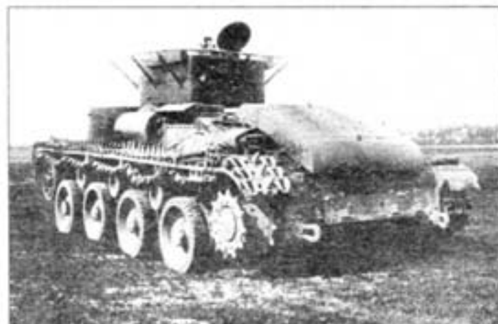
Эталонный образец колесно-гусеничного танка Т-29 с пушкой ПС-3 на полигонных испытаниях, вид сзади. Лето 1936 года. На фото испытание синхронизаторов – левый борт на колесах, правый на гусенице. Считалось, что это позволит вывести танк из боя при потере одной гусеницы.
