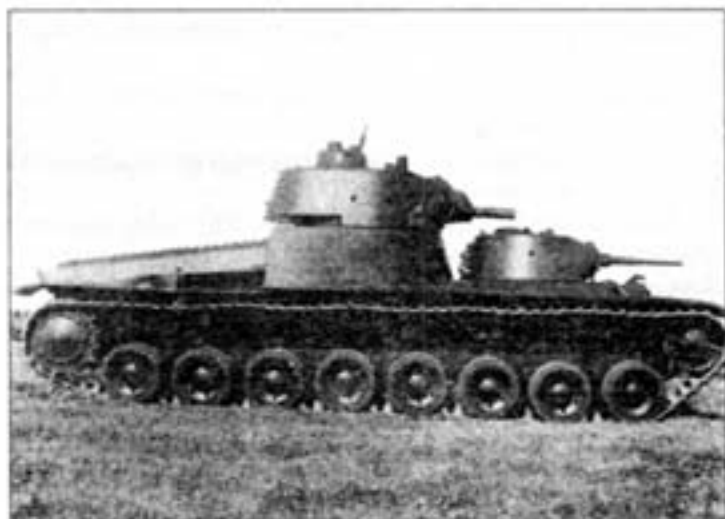
Танк Т-100 на полигонных испытаниях, вид с правого борта. Август 1939 года. На машине еще установлена 75-мм пушка Л-10.
