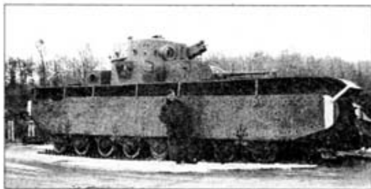
Немецкий солдат фотографируется на фоне Т-35. Район Лысова, октябрь 1941 года. Танк выпуска 1938 года с дополнительным бронированием шаровых установок малых башен.
