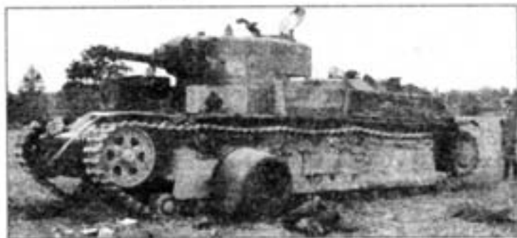
Подбитый Т-28 выпуска начала 1939 года с пушкой Л-10. Юго-Западный фронт, июль 1941 года. Немецкий снаряд разбил башню механика-водителя и снес левую пулеметную башню.
