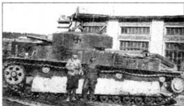
Трофейный Т-28 на финской службе. Весна 1942 года. Машина имеет дополнительную защиту маски пушки, установленную финнами в ремонтных мастерских в Вяркялусе.
