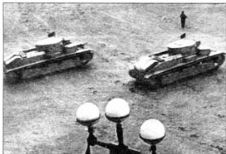
Первые серийные танки Т-28 на параде на площади Урицкого (ныне Дворцовая). Ленинград, 1 мая 1933 года. Хорошо видно, что ящики для приборов дымопуска еще не установлены, вместо них укреплены небольшие ящики для ЗИП.
