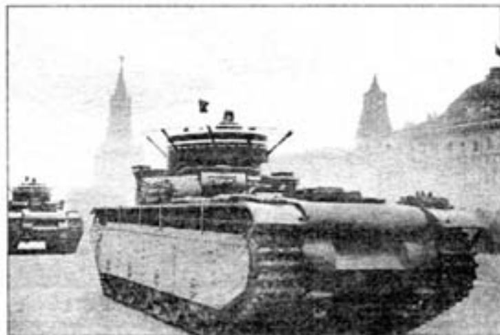
Т-35 на параде. 7 ноября 1935 года. Хорошо видна укладка брента и троса на левом борту танка.
