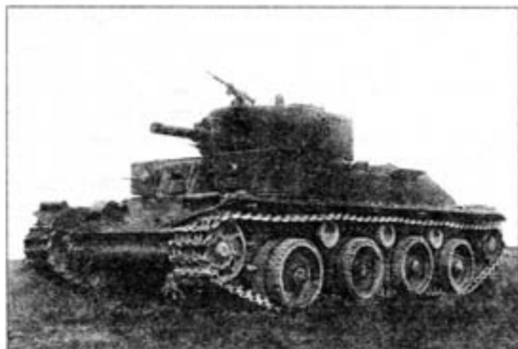
Эталонный образец танка Т-29, перевооруженный 76,2-мм пушкой Л-10. Лето 1938 года. Поручневая антенна с башни демонтирована.
