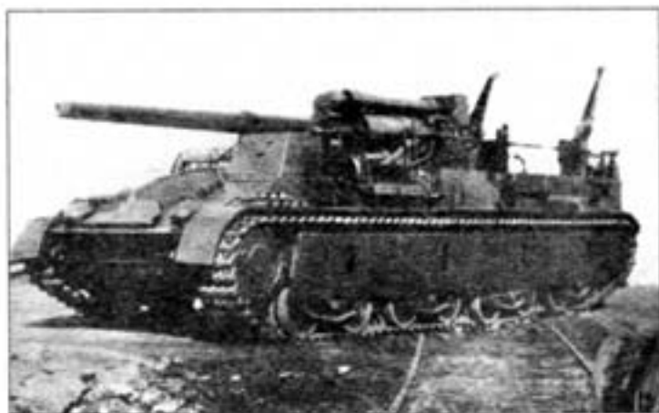
Общий вид модернизированного образца СУ-14 со 152-мм орудием большой мощности У-30. 1936 год.
