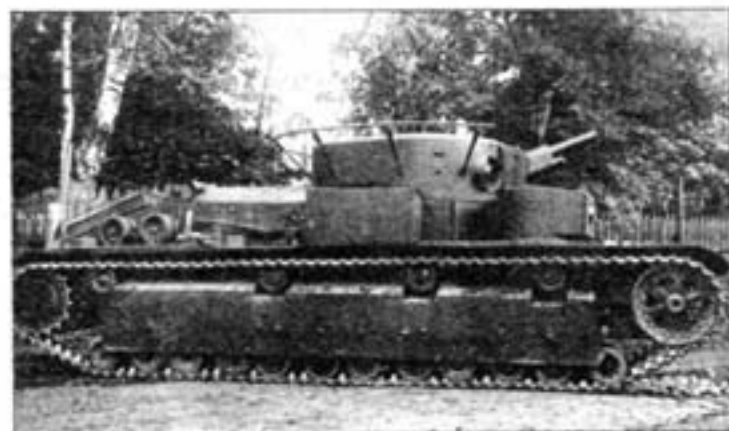
Испытание опытного образца 76,2-мм пушки Ф-32 в танке Т-28. Сентябрь 1939 года. Впоследствии эта артсистема была принята на вооружение и устанавливалась на танки KB-1.
