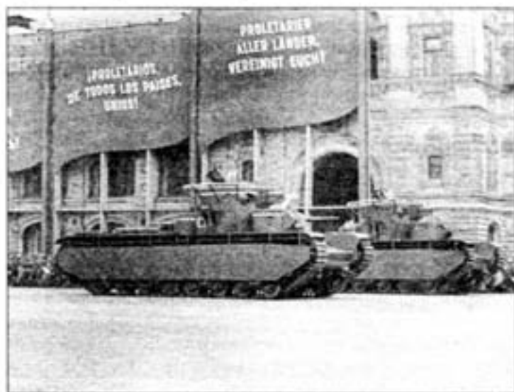
Танки Т-35 проходят по Красной площади. 1 мая 1937 года. Хорошо видна тактическая маркировка, антенна крепится на восьми стойках.
