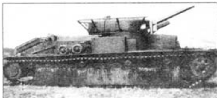
Испытание 76,2-мм танковой пушки ПС-3 № 59 в Т-28 с заводским № К-010 на Научно-испытательном артиллерийском полигоне. Август 1936 года. Несмотря на то что ПС-3 значительно превосходила КТ-28, ее так и не приняли на вооружение.
