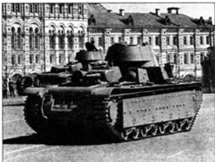
Танки Т-35 с коническими башнями на Красной площади. 1 мая 1941 года. На переднем плане машина с наклонной подбашенной коробкой.
