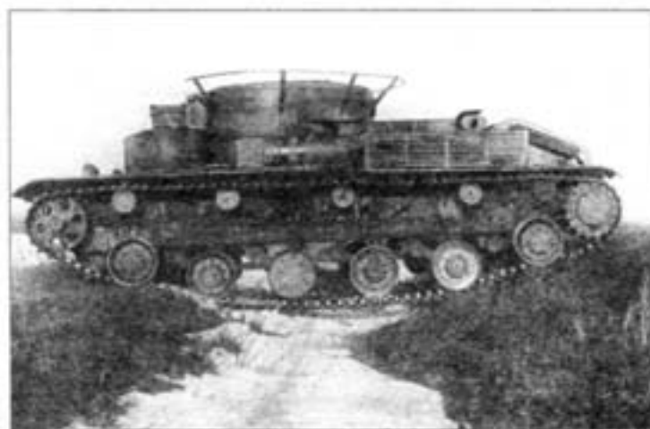
Испытания торсионной подвески на танке Т-28 № 1552. Февраль 1939 года.
