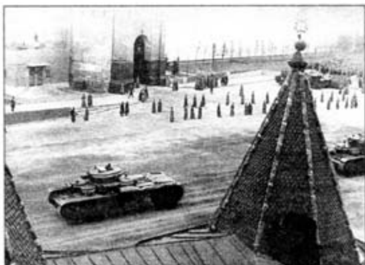
На этом снимке, сделанном с собора Василия Блаженного, виден общий люк в крыше главной башни и глушитель, установленный поперек корпуса – детали, характерные для Т-35А выпуска до 1937 года.
