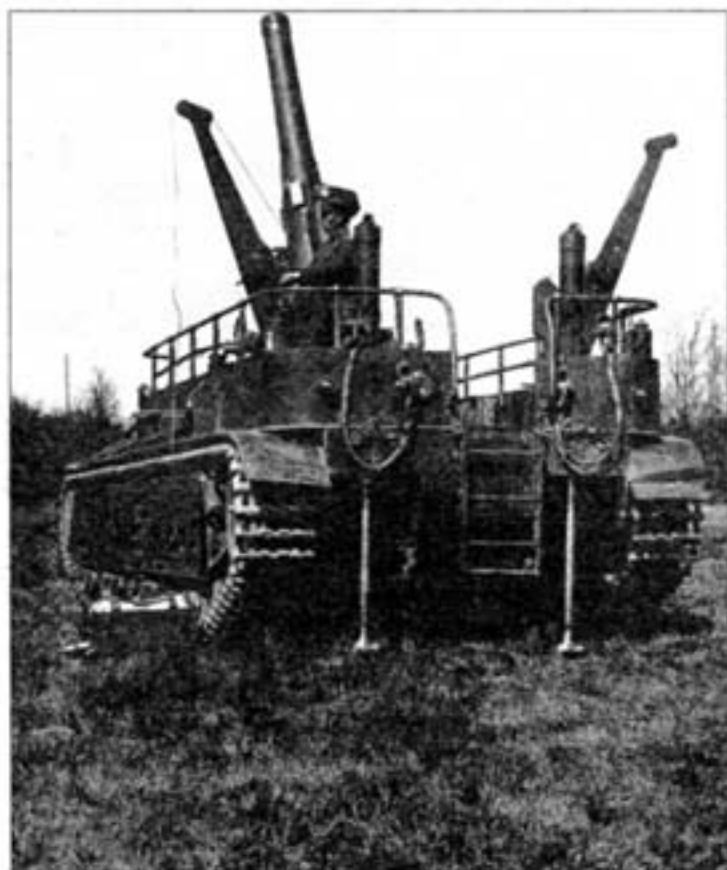
СУ-14-1 перед стрельбой. Весна 1936 года. Домкраты опущены, краны развернуты в положение для подьема боеприпасов.
