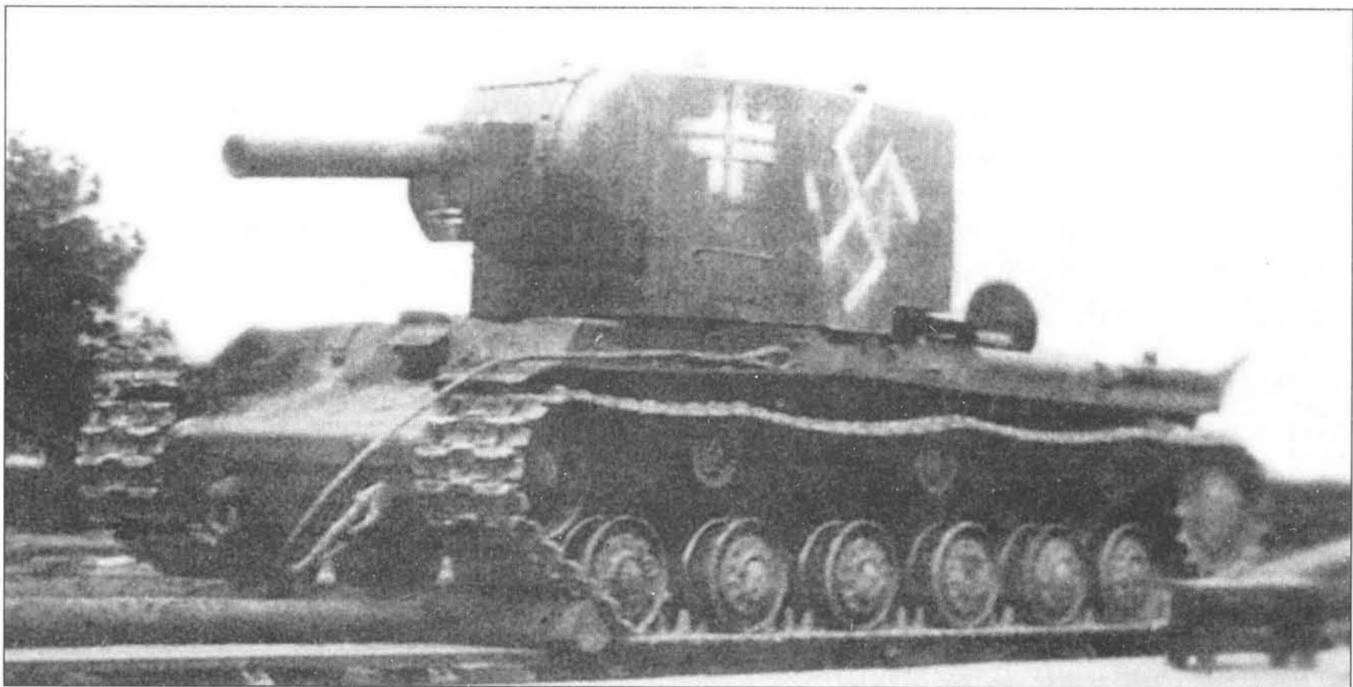
Данная фотография демонстрирует применение немецких опознавательных знаков: Balkenkreuz (балочный крест) на борту баини и на маске орудия, а также свастика увеличенных размеров.
