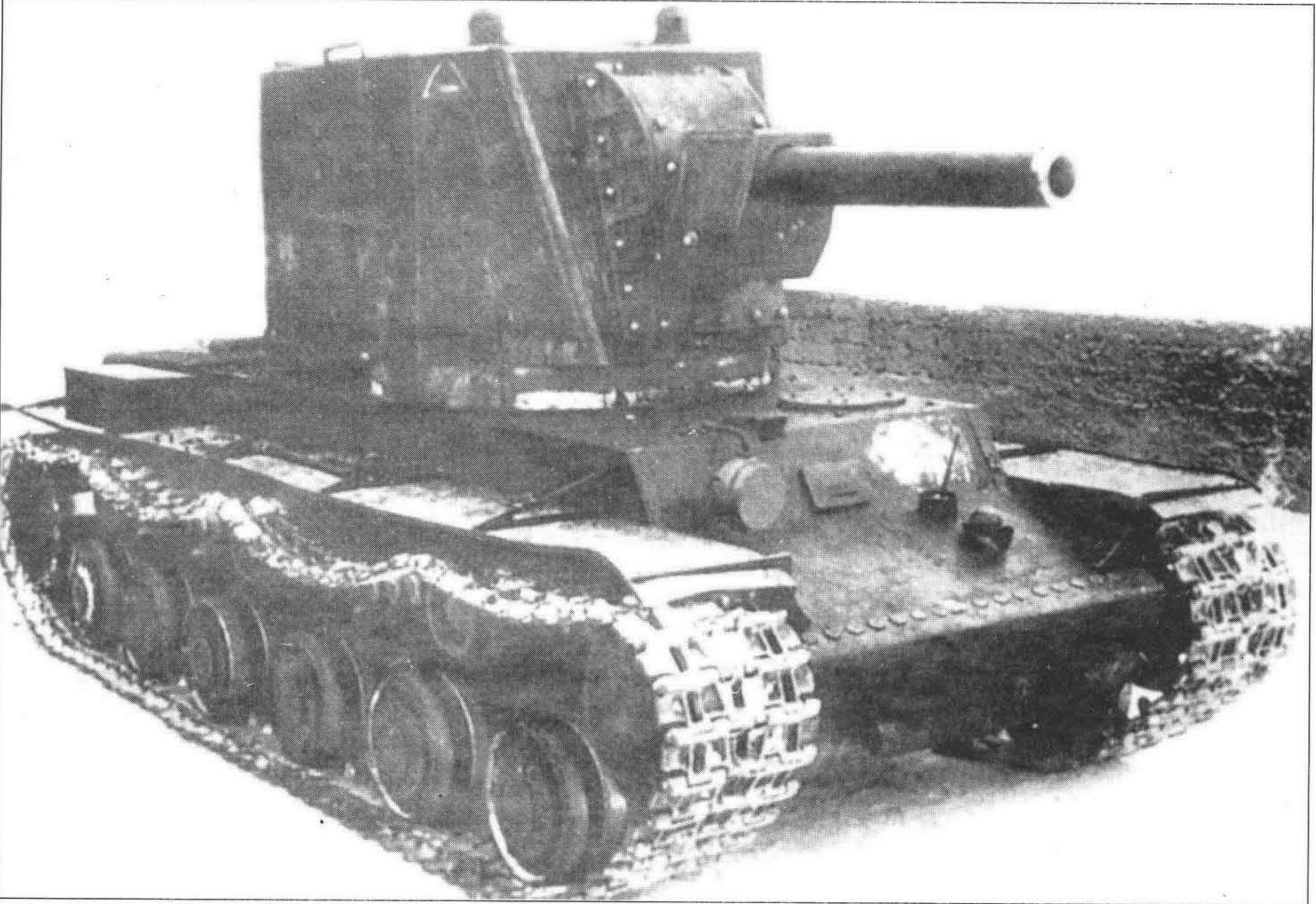
Фотография первого прототипа КВ-2, заводское обозначение У-0. Машина оснащена 152,4 мм гаубицей М-10С в башне МТ-1. Этот танк был отправлен 16 февраля 1940 года на Финский фронт. Обратите внимание на ранний вариант бронирования люка механика-водителя и конструкцию башни, типичную для всех ранних предсерийных КВ-2.
