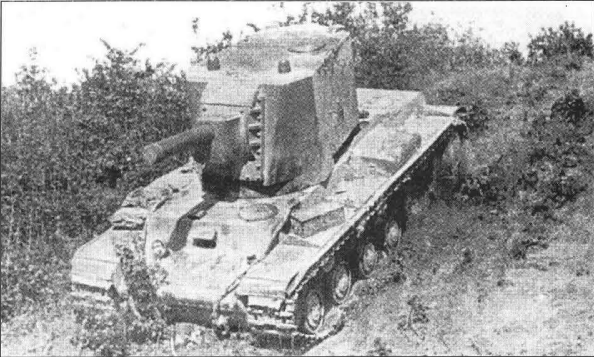
Прототип У-1 во время ходовых испытаний под Ленинградом в июне 1940 года, обратите внимание на оригинальный люк механика-водителя, и расположение люка на крыше башни, на более поздних серийных машинах он был сдвинут вправо.
