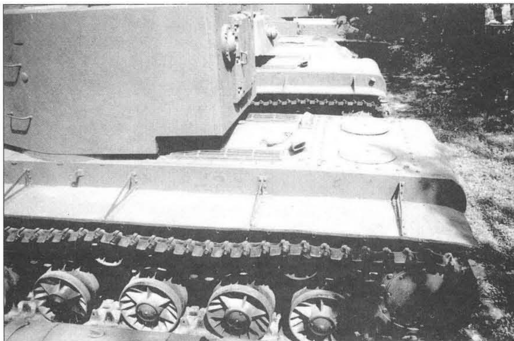
Крыша МТО (слева направо): воздухозаборники, выхлопная система и люки обслуживания.
