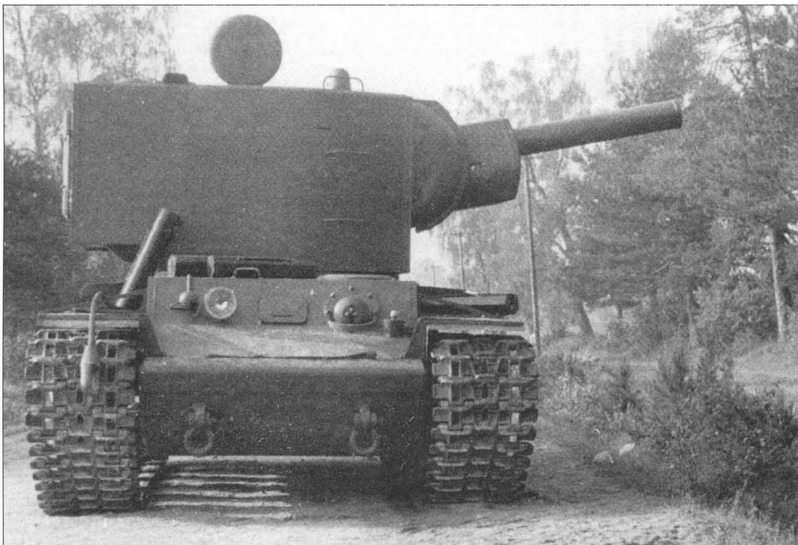
Другой танк KV-2, оставленный на обочине дороги в Ленинградской области также выглядит практически неповрежденным. Частые поломки матчасти приводили к большим потерям в подразделениях KV-2.
