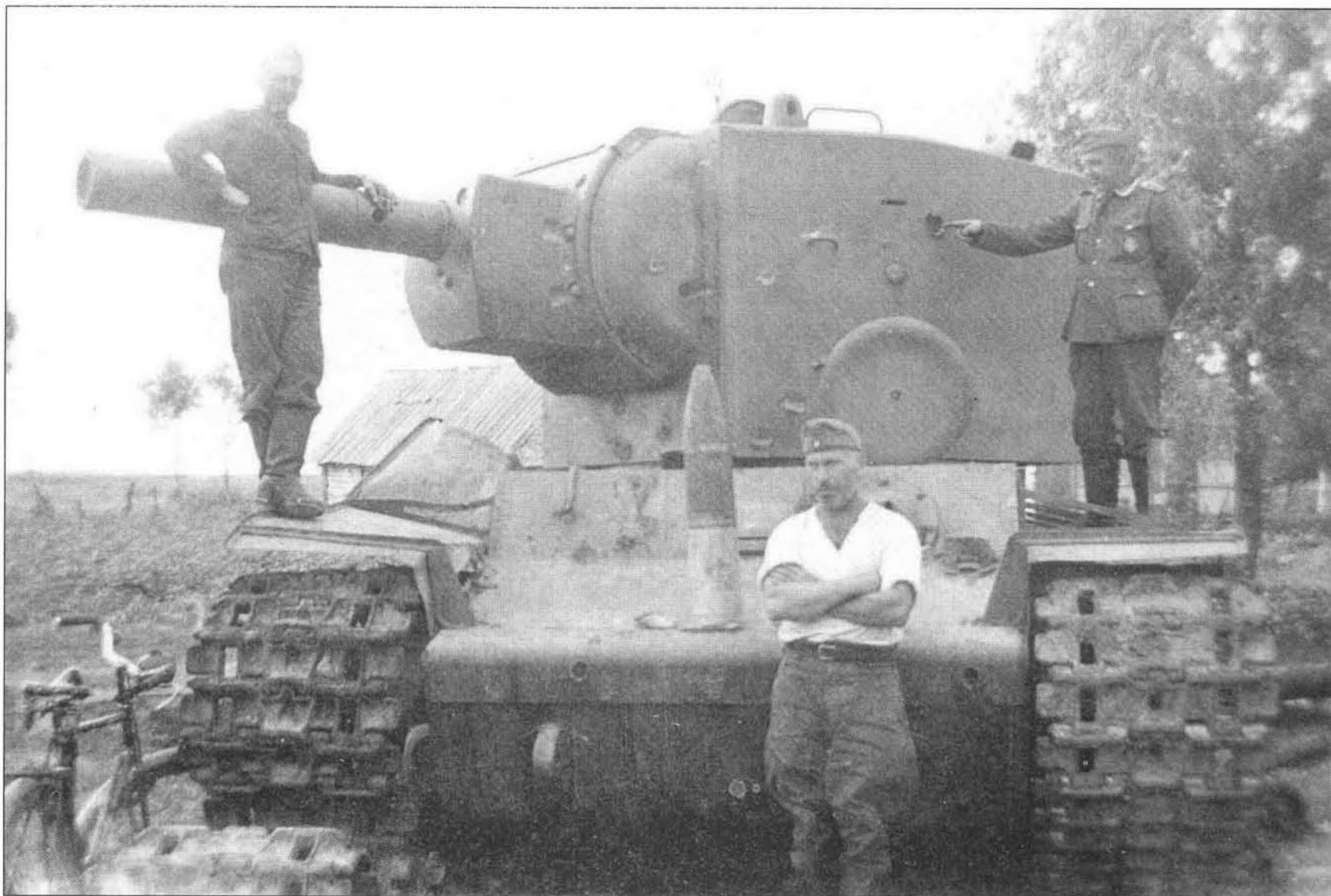
КВ-2 образца 1940 года, захваченный немцами. Обратите внимание на пробоины в бортовой броне башни (МТ-2).
