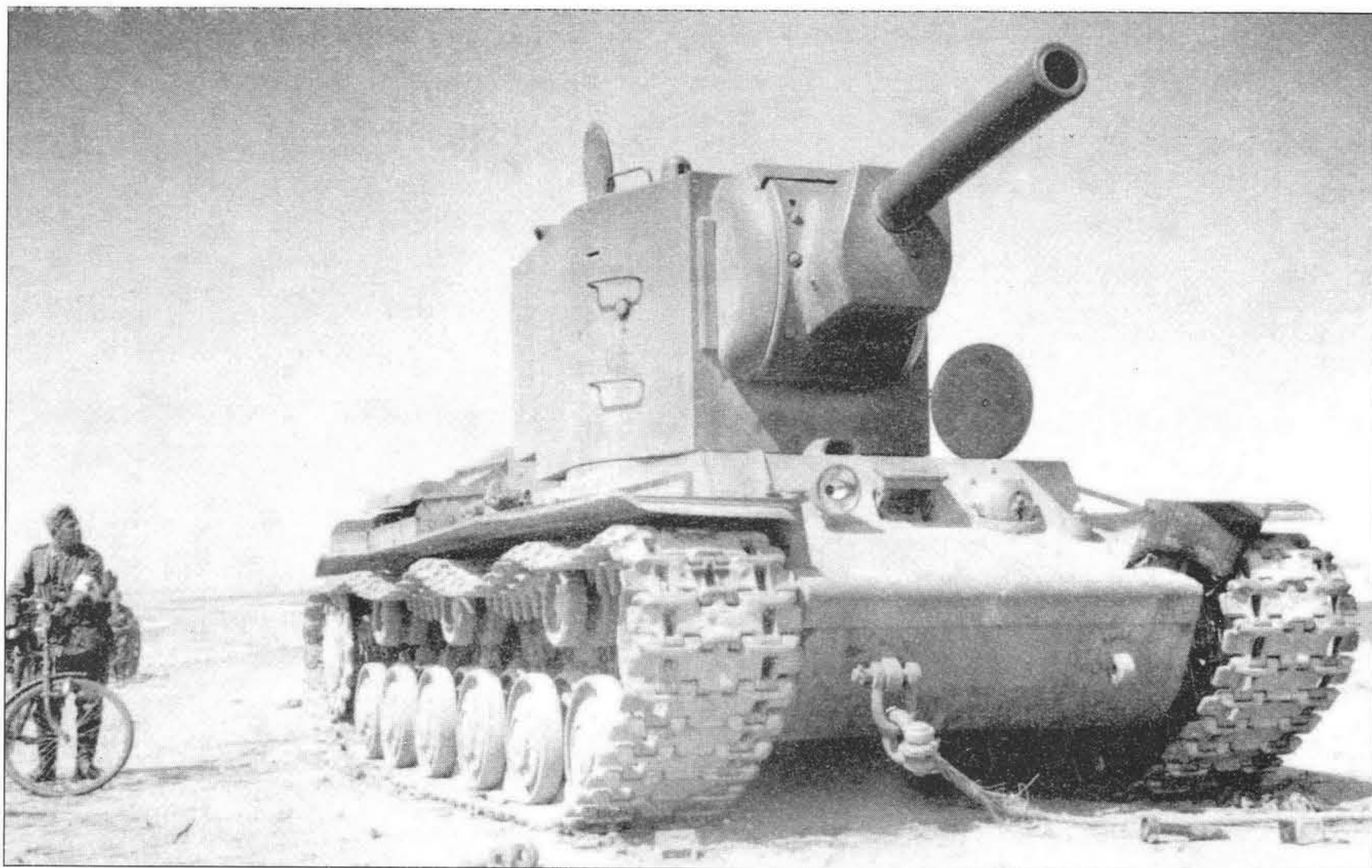
Глядя на эту фотографию, становятся очевидными внушительные размеры KV-2 и его воздействие на психику германских солдат. Пораженный немецкий санитар на велосипеде осматривает «Russischen Koloss». Одним из главных недостатков конструкции KV-2 была ненадежность шасси и трансмиссии, которые были перегружены из-за возросшего веса танка.
