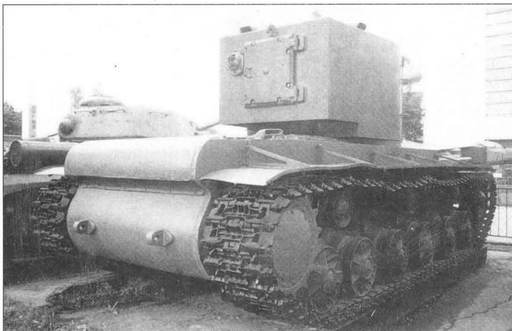
Корма корпуса с правой стороны с деталями шасси и креплениями надгусеничных полок.
