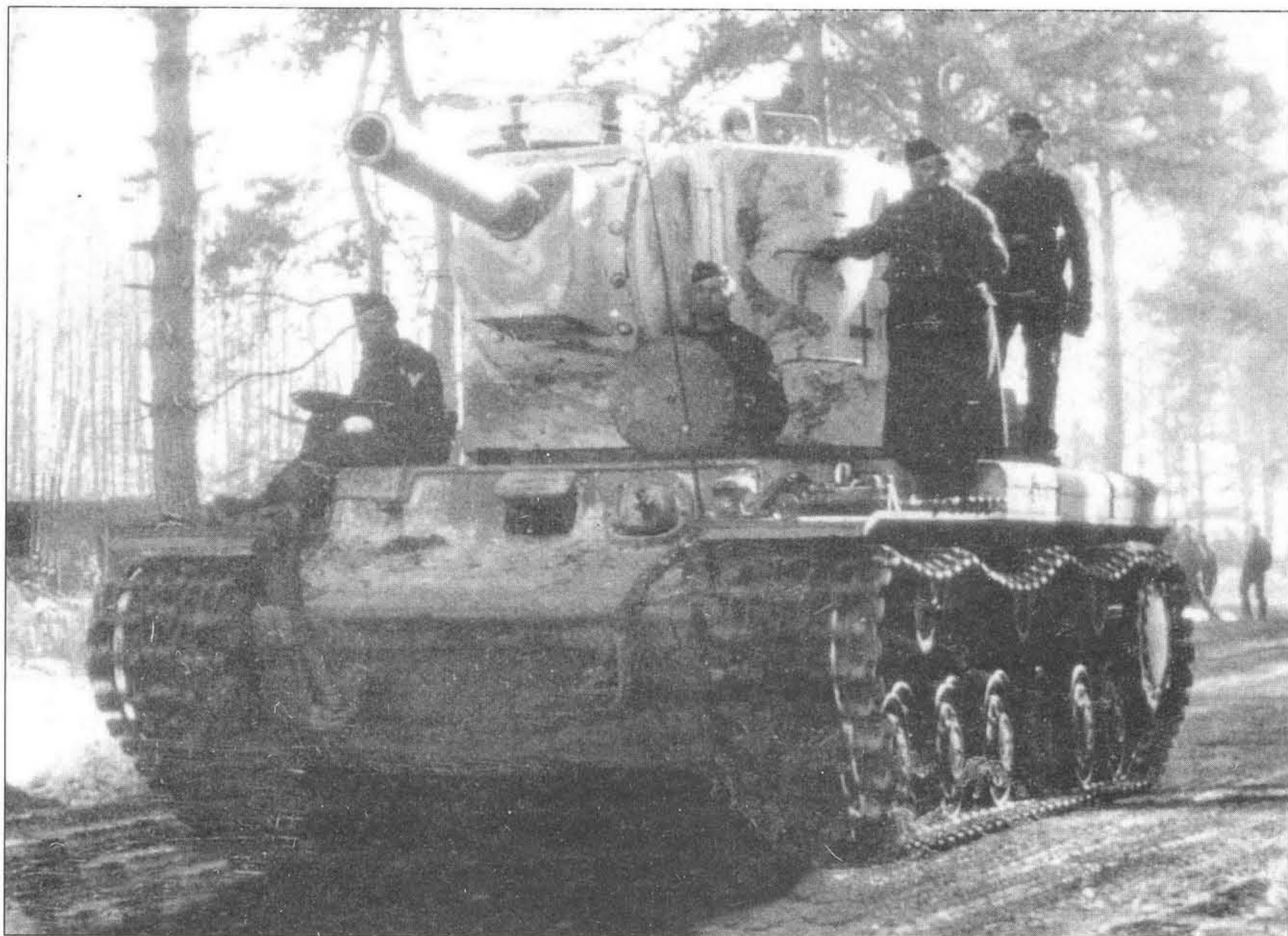
Panzerkampfwagen KW-II 754 (r) на службе в Вермахте. Обратите внимание на командирскую башенку 6./ZW с немецкого танка Panzerkampfwagen III G/IV E, зимний камуфляж и маленький Balkenkreuz, нарисованный на борту башни.
