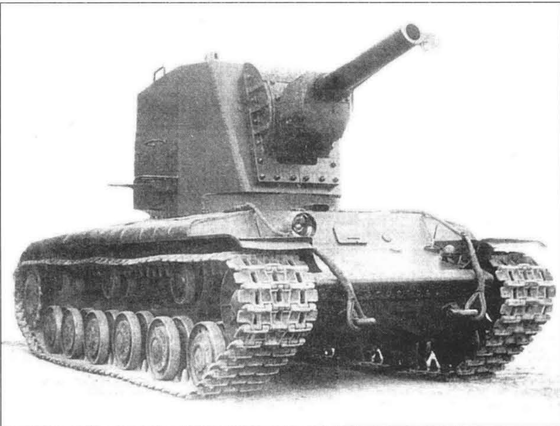
Опытная машина У-3, которая 22 февраля 1940 года вместе с У-2 оснащенной 76 мм пушкой также была отправлена на фронт для проведения испытаний. Обратите внимание на механизм закрывания канала ствола.
