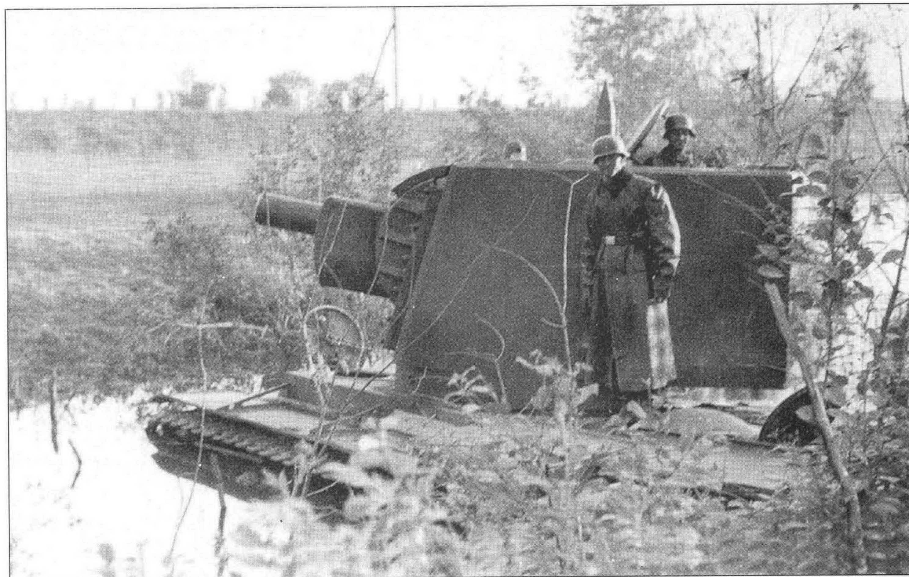
На этих четырех фотографиях KV-2 образца 1939 года, подбитый немецкими войсками в июле 1941 года в Прибалтике (относительно недалеко от Кировского завода). Вероятнее всего, он входил в состав 20-й тяжелой танковой бригады и увяз в болоте. Судя по характерным деталям, это опытная машина У-4 - три поручня-ступеньки на бортах башни и надгусеничные полки позднего образца.
