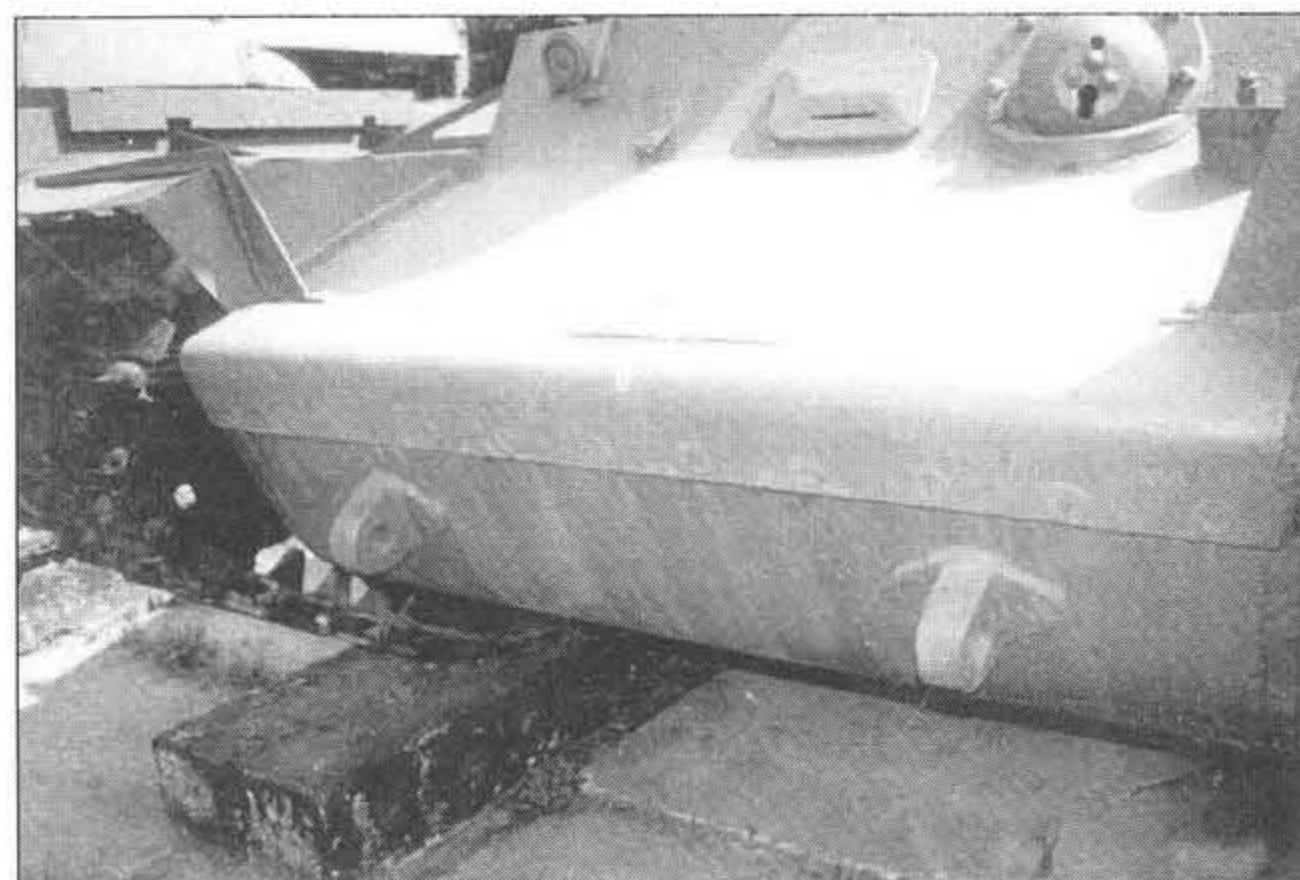
Передний нижний наклонный лист корпуса с буксирными петлями.
