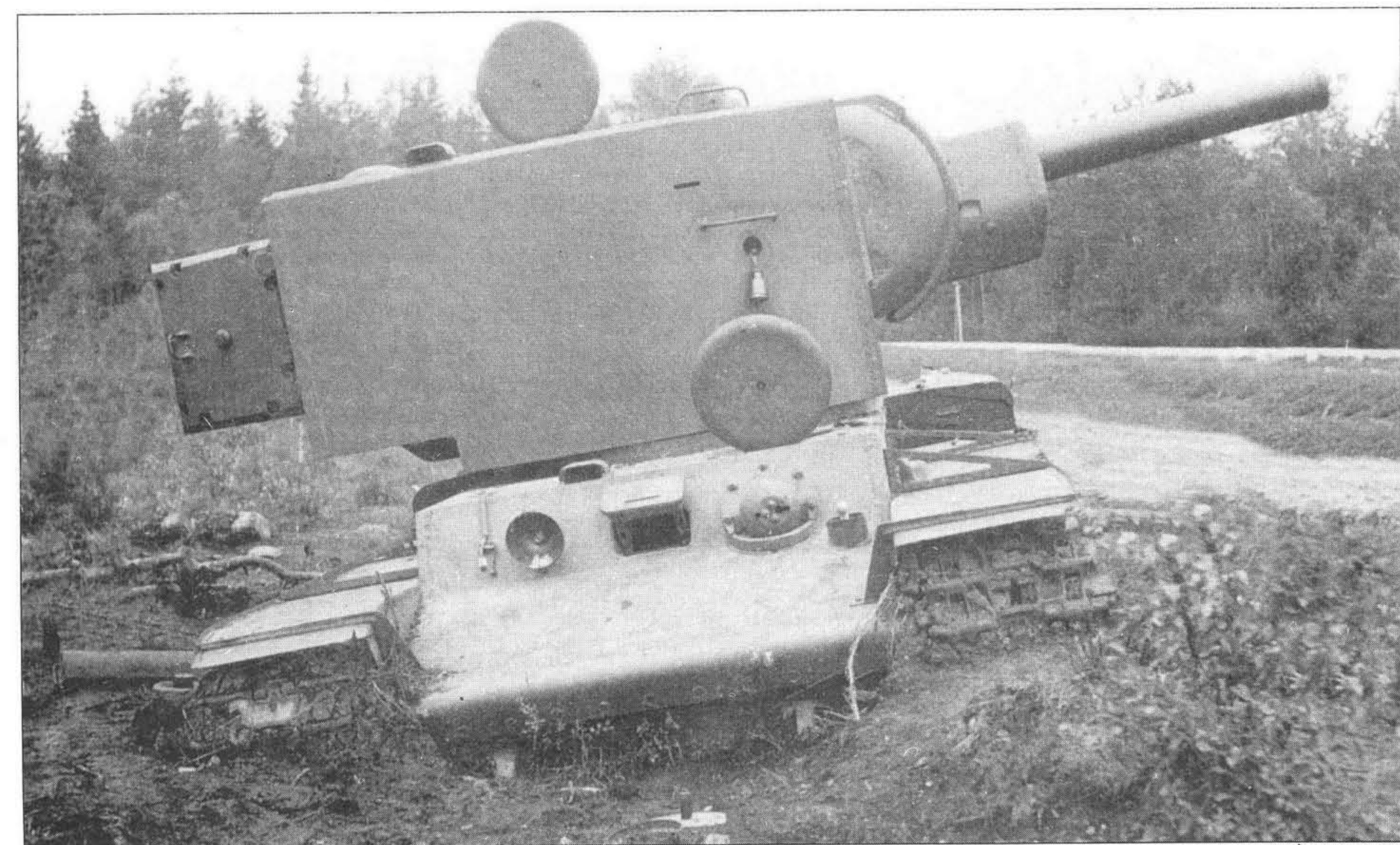
Брошенный КВ-2, его башня развернута на левый борт. При таком повороте из орудия уже нельзя было вести огонь. Танк, очевидно, застрял на мягкой обочине и был оставлен экипажем в практически исправном состоянии.
