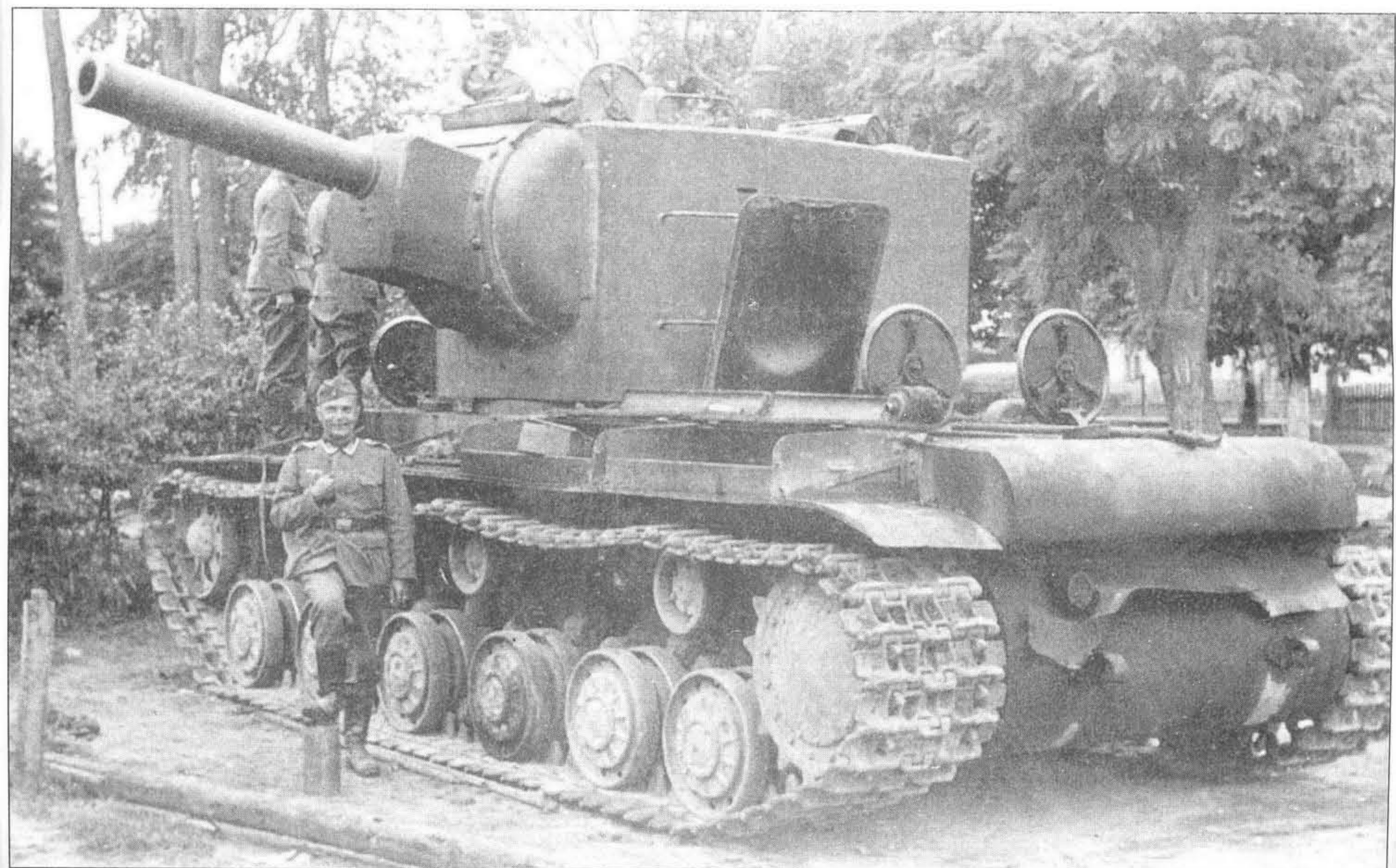
На этом захваченном немцами KB-2 хорошо видна конструкция люка доступа к двигателю В-2 и ящиков на надгусеничных полках.
