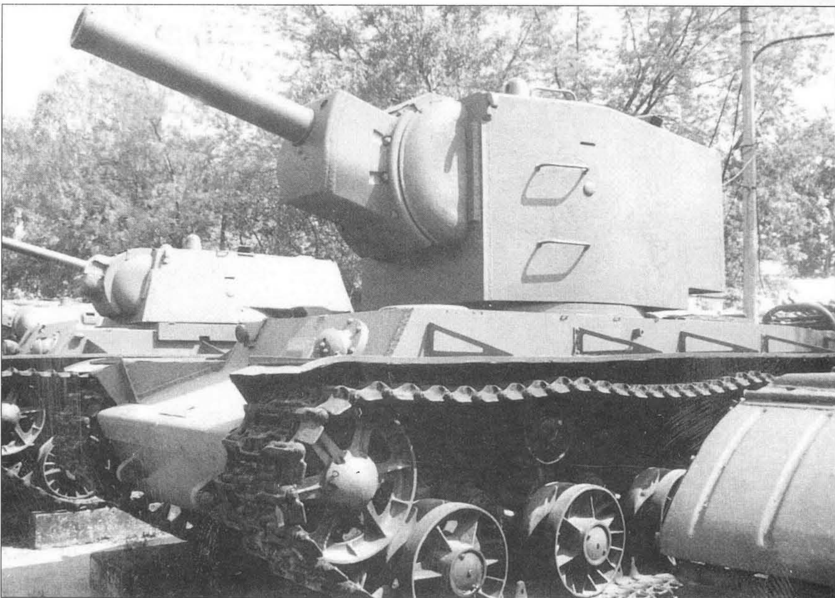
Единственный сохранившийся экземпляр КВ-2, демонстрирующийся в Музее Вооруженных Сил в Москве. На нем установлены опорные катки от поздних КВ-1.
